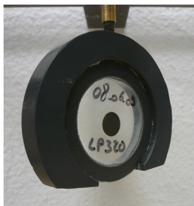
FIG. 2.8 – Cible LP320 montée sur son support.
