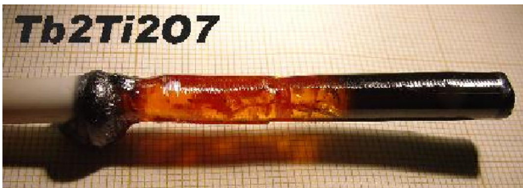
FIGURE 4.1 – Cristal de Tb 2 Ti 2 O 7 (échantillon A ) à la sortie du four à image.
