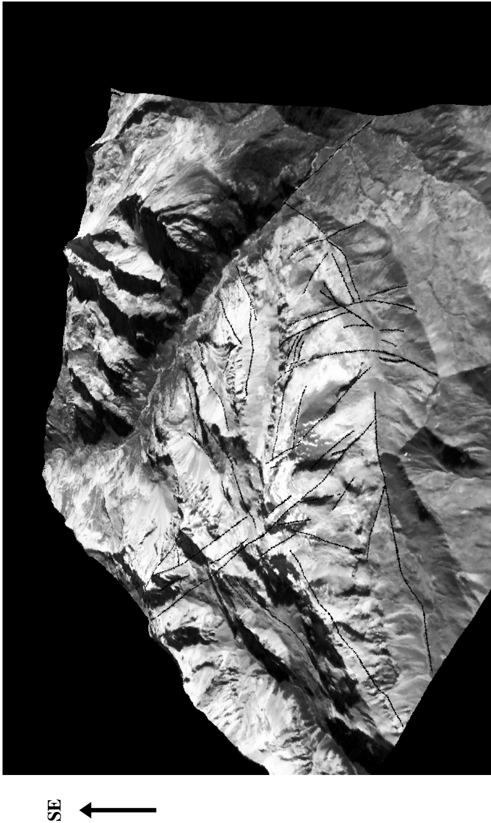
Figure 2.23 - Schéma de la fracturation en 3D du massif Mortice - Font Sancte plaqué sur le MNT et l'image SPOT (vue vers le SE). L'analyse multi-sources de cette zone a permis de caractériser un réseau de failles local très dense, étroitement lié à la morphologie du site.
