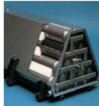
Graphique 24. Etat de l'art des différents systèmes de stockage d'hydrogène à bord de la voiture
