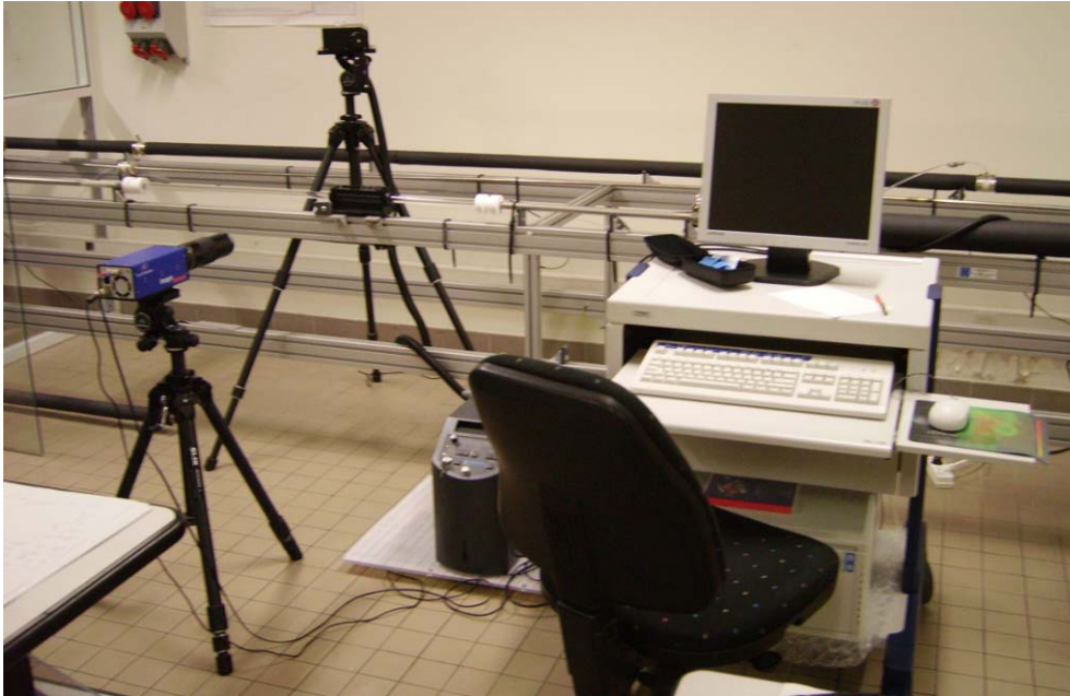
Fig. 2-7 : photo du montage du système PIV sur la boucle d'essai expérimentale.
