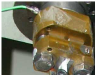
Figure 4.32: Vue du capteur de force installé juste derrière le mors dans l'environnement dynamique. Figure 4.33: Vue du capteur de déplacement laser/fibre optique dans l'environnement dynamique.
