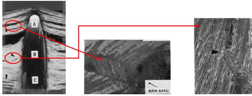
Figure 2.10: Coupe post-mortem des dommages. Coupes micrographiques après perforation montrant les zones de fragmentation dans les plis tissés, d'après Espinosa et al (2001) .
