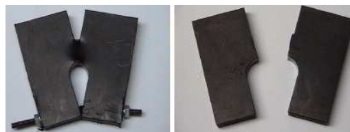
Figure 1.9: Différence de faciès de rupture pour un même matériau PE : rupture statique de type ductile (à gauche) et rupture dynamique de type fragile (à droite), d'après Soumahoro (2005.) .
