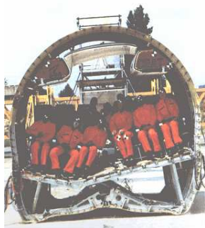
Figure 1.2: Test de crash à l'échelle 1 sur un tronçon représentatif d'avion (source CEAT).
