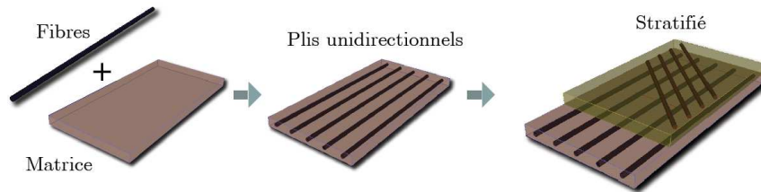
Figure 1.3: Composition d'un composite stratifié.
