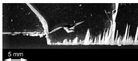
Figure 4.47: Observation expérimentale de branchements secondaires sur matériau homalite après une propagation intersonique, d'après Samudrala et al (2002).
