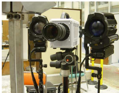
Figure 4.18: Caméra rapide Photron et deux projecteurs HMI Dedolight 2 \times 400 W.
