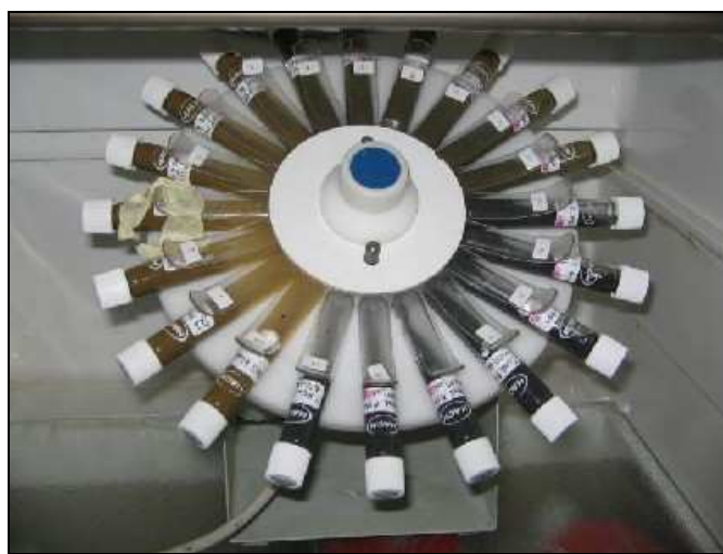
Figure 3. 5 Incubation des mélanges sols et cendres avec les herbicides atrazine et hexazinone dans le noir au réfrigérateur à 4°C
