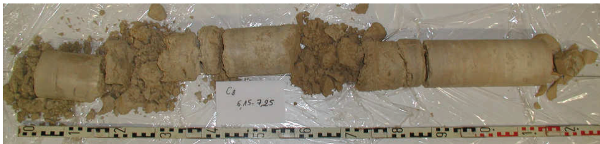
Figure 2.18 – Exemple de carotte provenant du sondage C2 de 6,15 à 7,25 m sous la surface du sol
