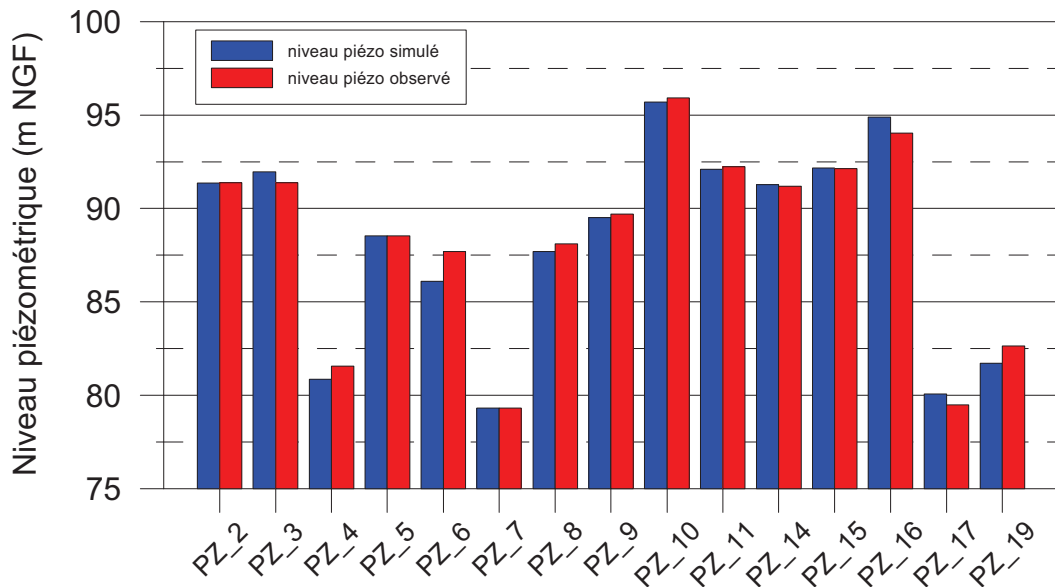
Figure 3.12 – Comparaison des niveaux piézométriques observés et simulés par le modèle 2D en régime permanent
