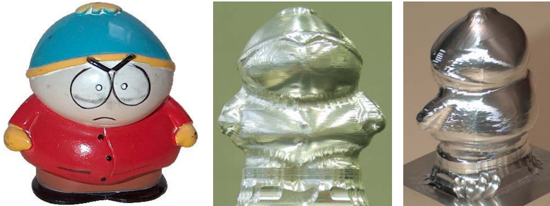
Figure 1.7 : Première pièce issue de la chaîne de copiage direct à 5 axes
