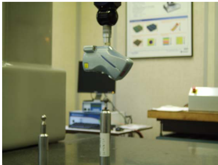
Figure A 1 : Mesure de sphère d'étalonnage avec une seule orientation Capteur
