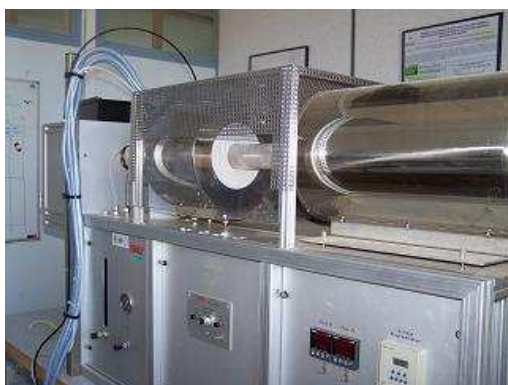
Figure 26 : Clichés du four de combustion et d'oxydation catalytique des échantillons permettant l'extraction du tritium organiquement lié non échangeable.
