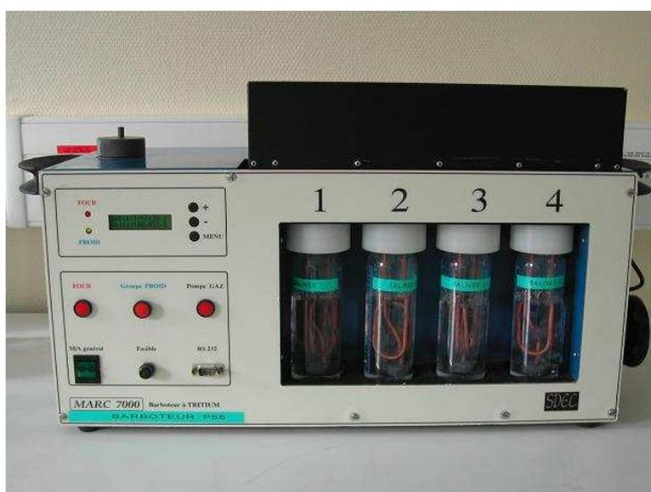
**Figure 38 : Photographie d'un barboteur utilisé dans cette étude pour le piégeage du tritium atmosphérique (MARC 7000, SDEC, Reignac sur Indre, France).**
