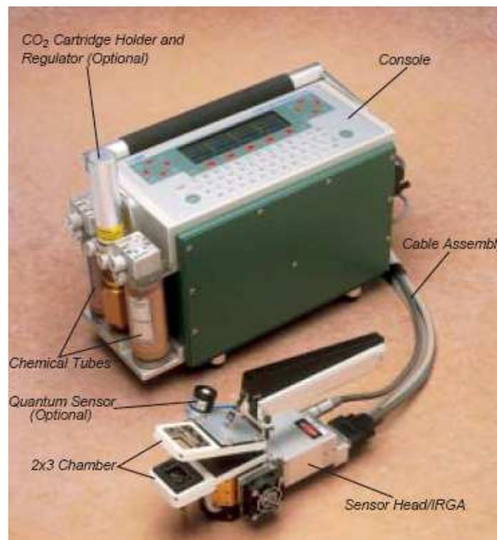
**Figure 19 : Cliché de la LI-6400 avec chambre ouverte pour la mesure d'une surface foliaire de 4cm<sup>2</sup> (extrait du manuel d'utilisation de l'appareil<sup>2</sup>).**
