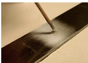
FIG. 9.4: Ajout de résine conductrice dans le film de colle
