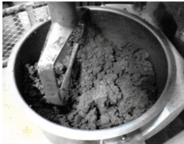
Figure 3-5 : Préparation de l'argile avant le compactage
