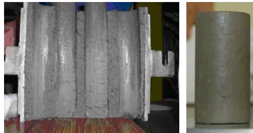
Figure 3-10 : Le moule CBR et l'échantillon testé ( \phi = 35 \text{ mm} , H = 70 \text{ mm} )
