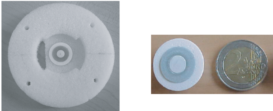
FIG. 3.20 – Photographies de la lentille HMFE à 3 coquilles avec et sans son support en mousse.
