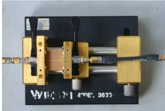
FIG. 1.6 – Technique de mesure avec Cellule Wiltron.
