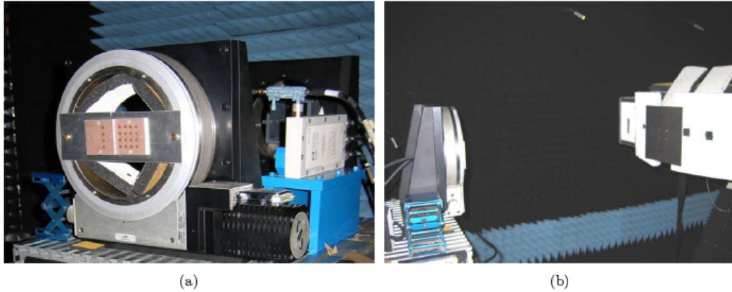
FIG. 2.20 – Mesures en chambre anéchoïque - (a) antennes sur la tourelle d'émission (b) cible sur la tourelle de réception
