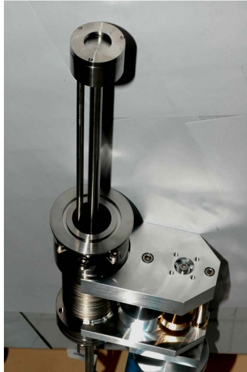
Figure 2-5 : Schéma et photographie de l'électrode porte-échantillon refroidie par un circuit d'eau
