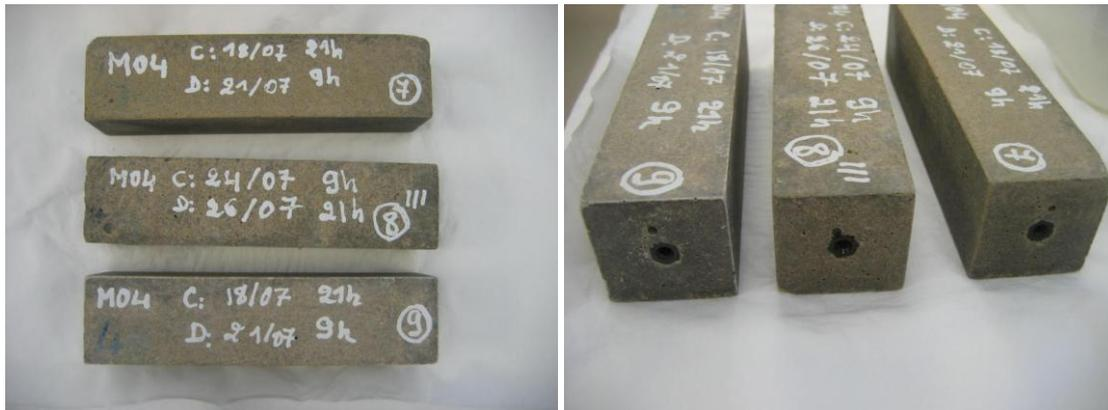
*Figure III-60 : Mortiers en CEM I/49 à la fin du protocole Immersion complète*
