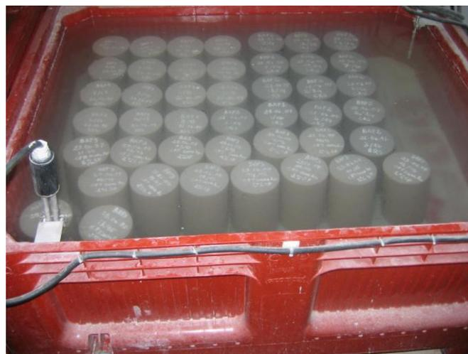
*Figure III-8 : Mode de conservation des éprouvettes*
