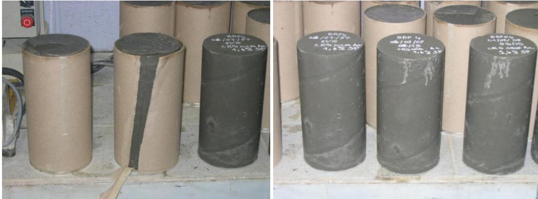
*Figure III-6 : Confection des éprouvettes cylindriques en béton autoplaçant*
