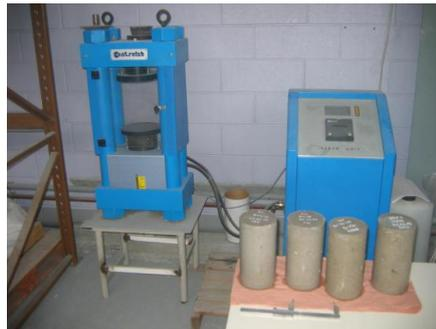
Figure III-3 : Presse des éprouvettes 11x22cm de l'Ecole Polytechnique d'Orléans
