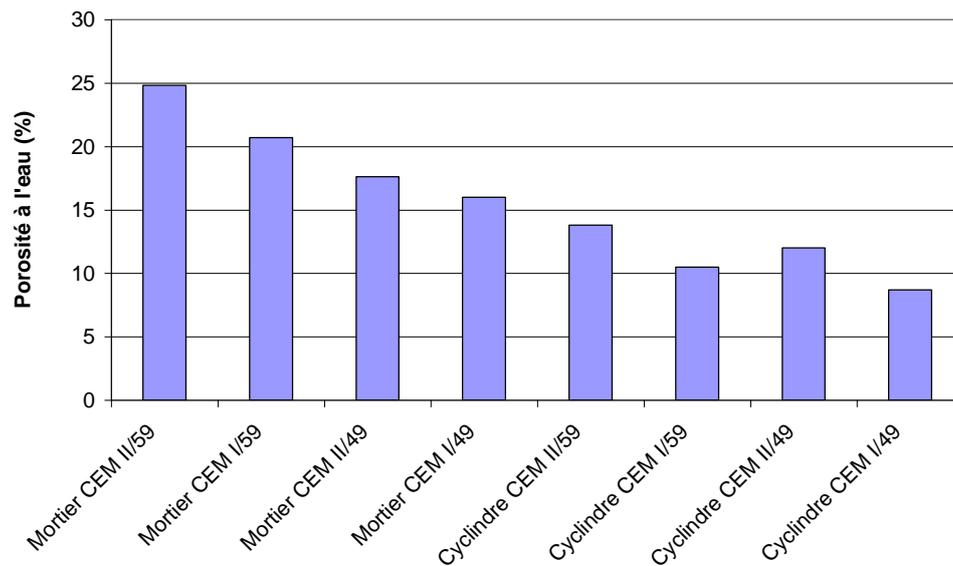
*Figure IV-10 : Porosité totale à l'eau des échantillons sains*
