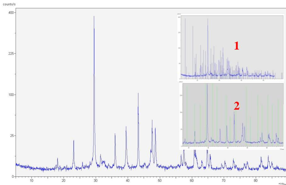
*Figure IV-26 : Diffractogramme sur poudre - CEM II/59 en Immersion /Séchage à 105°C : Intensité =  $f(2\theta)$  avec références de l'ettringite (1) et de la mirabilite (2)*
