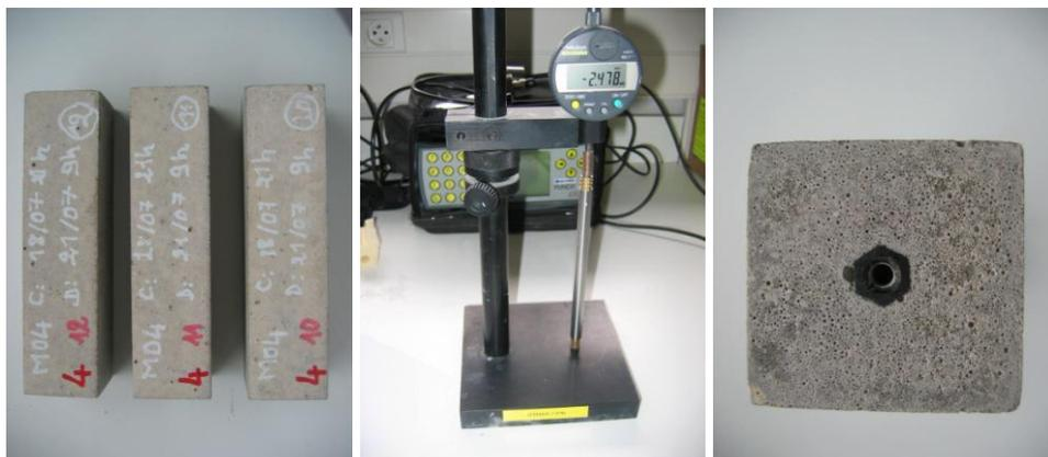
Figure III-20 : Prise hebdomadaire de l'allongement pour les mortiers munis de plots
