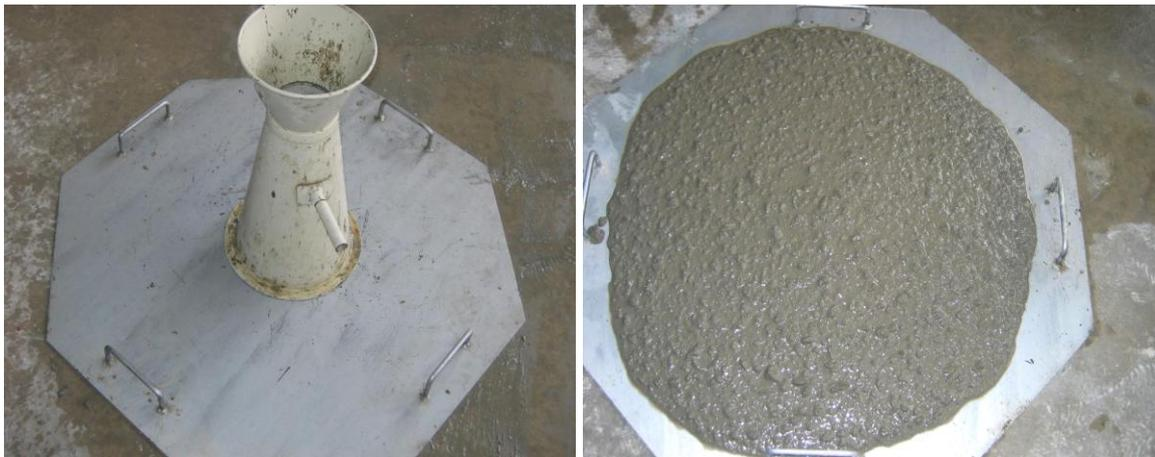
*Figure I-2 : Essai d'étalement au cône d'Abrams (slump flow)*
