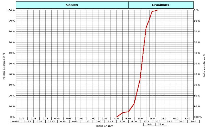
Figure II-5 : Courbe granulométrique du gravier 8/15
