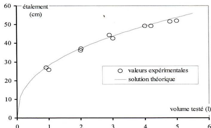
*Figure II-19 : Etalement en fonction du volume de matériau testé pour une pâte de ciment dont le seuil mesuré au viscosimètre est de 60 Pa, La solution théorique et les résultats expérimentaux sont reportés [70]*
