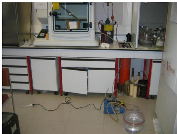
*Figure III-17 : Dispositif de purge de l'armoire à condensation du SO<sub>2</sub>*
