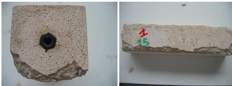
Figure III-28 : Endommagement localisé des mortiers issus des bétons CEMII/59 - Immersion/séchage à 105°C
