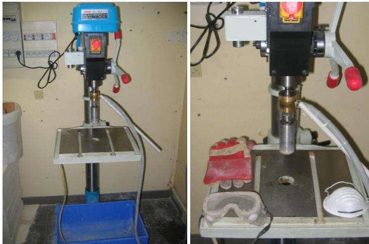
*Figure III-10 : Carotteuse du laboratoire du CRMD d'Orléans*
