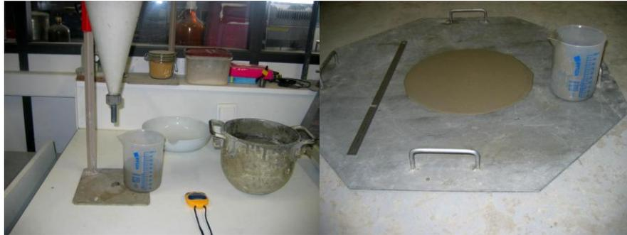
*Figure II-18 : Essai de mesure du seuil de cisaillement selon Roussel et Coussot*
