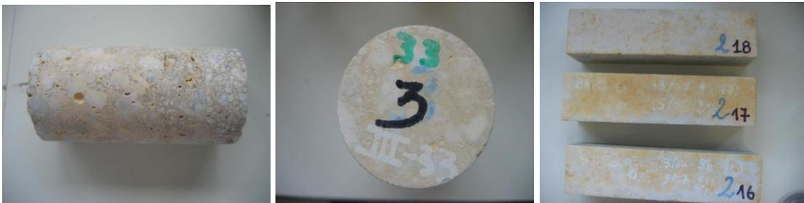
Figure III-22 : Mini-cylindres de béton et des mortiers soumis au brouillard salin
