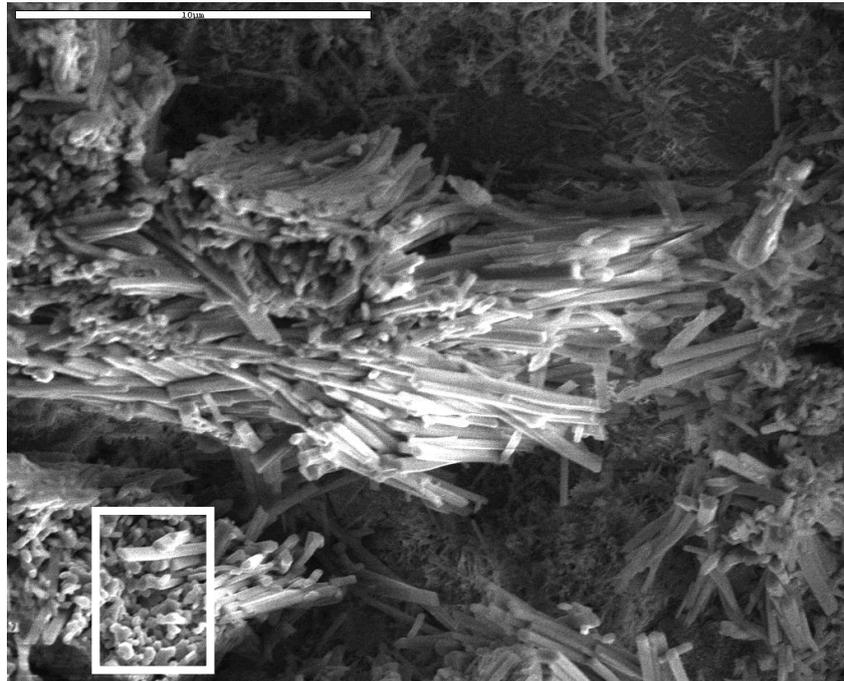
*Figure IV-45 : Fracture (x5000/5kv) - CEMII/59 en I/S à 60°C*
