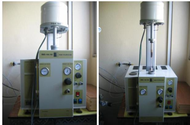
Figure IV-13 : Dispositif utilisé pour l'analyse thermogravimétrique – Université d'Orléans
