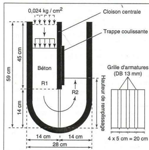
Figure I-5 : Essai du tube en U
