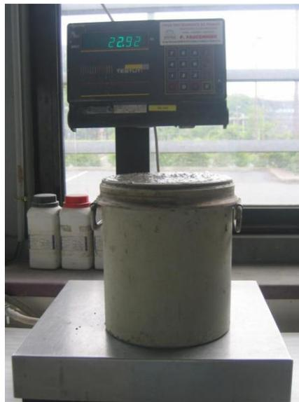
*Figure I-12 : Mesure de la masse volumique réelle*
