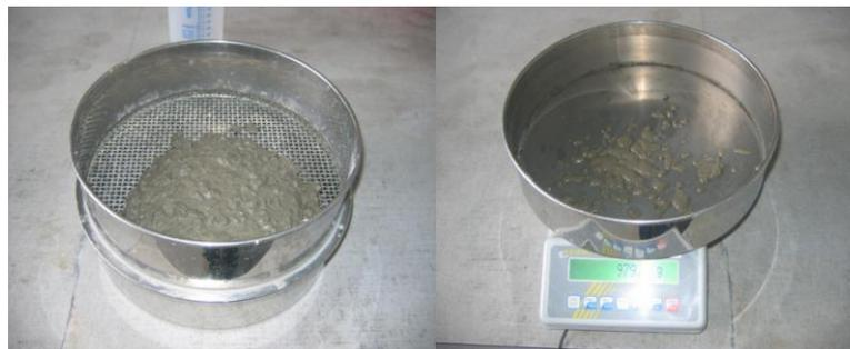
Figure I-8 : Essai de stabilité au tamis
