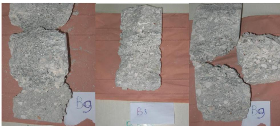
*Figure II-17 : Eprouvettes 11x22cm après écrasement à la compression*
