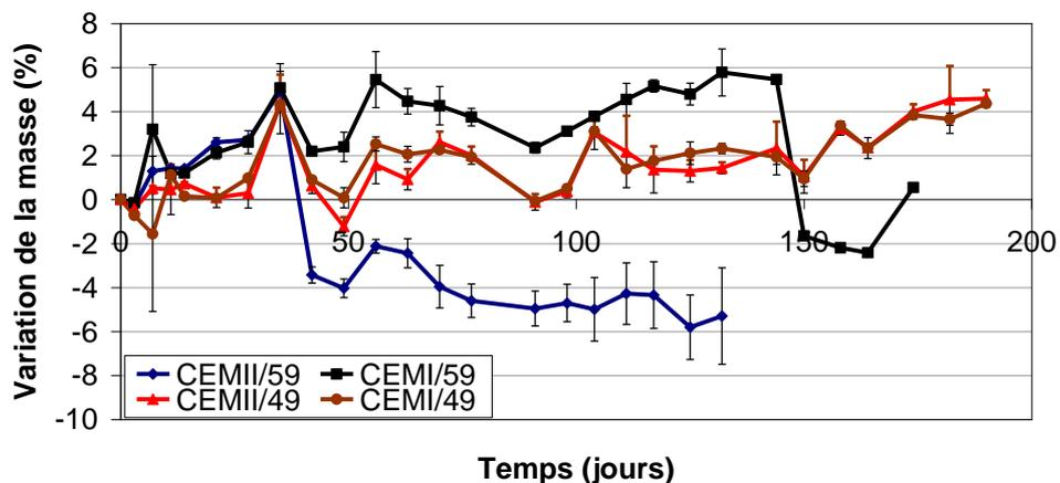
Figure III-35 : L'évolution de la masse des mortiers en fonction du temps - Immersion/séchage à 105°C
