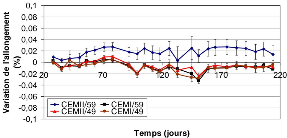
Figure III-44 : Variation de l'allongement des mortiers au cours du temps - Immersion/séchage à 60°C
