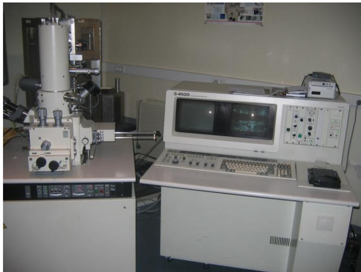
*Figure IV-27 : Microscope électronique à balayage de l'université d'Orléans*
