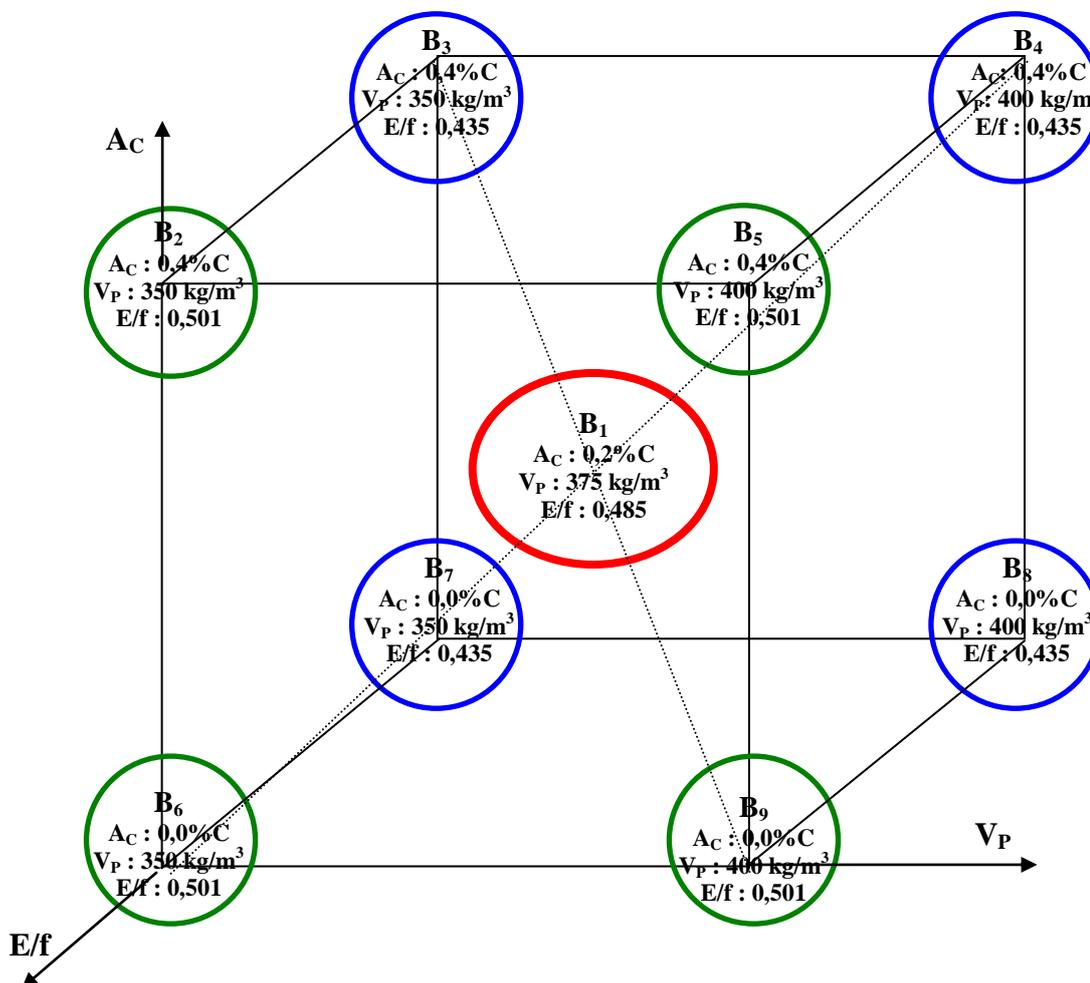
Figure II-10 : Caractéristiques des différents bétons à confectionner
