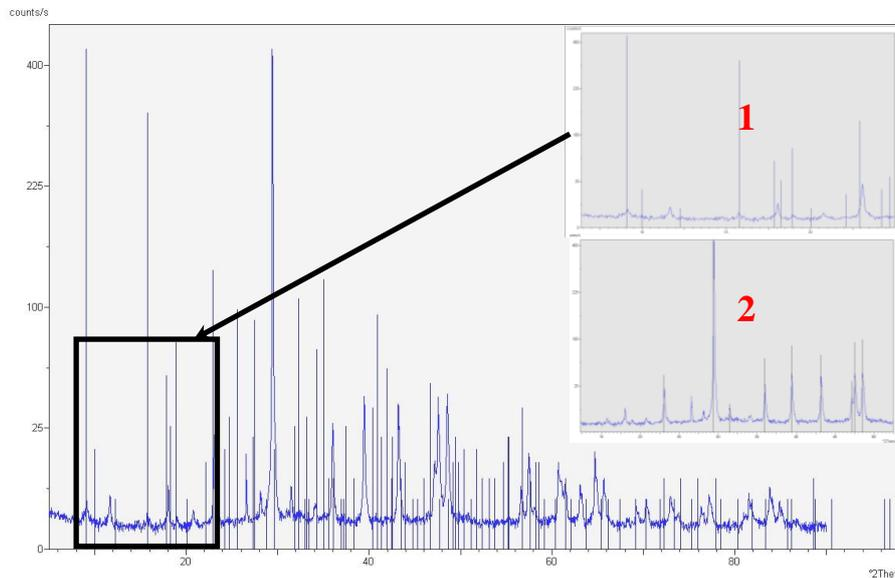
*Figure IV-24 : Diffractogramme sur poudre - CEM II/59 en Immersion complète : Intensité =  $f(2\theta)$  avec références de l'ettringite (1) et la calcite (2)*
