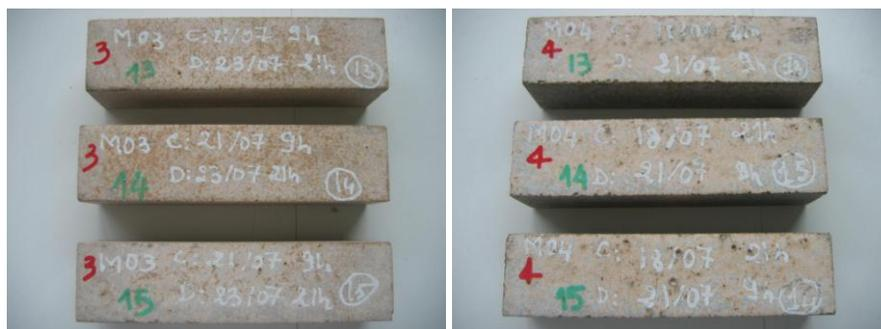
*Figure III-31 : Echantillons de mortier issus des bétons CEMII/49 et CEMI/49 restés intacts face à l'immersion/séchage à 105°C*
