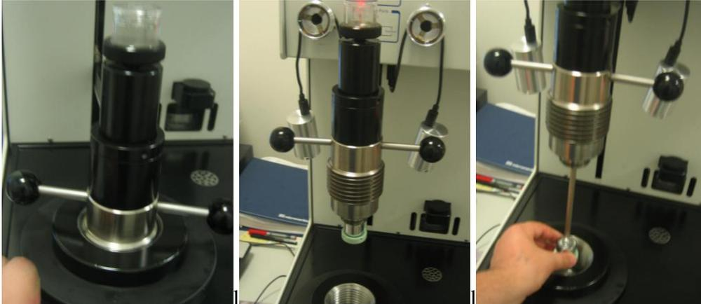
*Figure IV-5 : Mesure de la porosité au mercure à haute pression*
