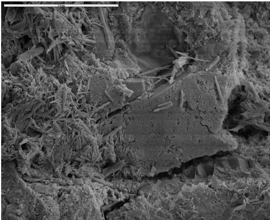
*Figure IV-37 : Fracture (x1000/5kv) - CEMII/59 en IC*
