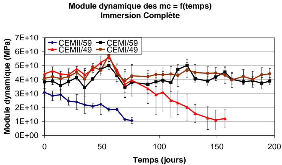
Figure III-53 : Variation du module dynamique des mini-cylindres en fonction du temps - Immersion complète
