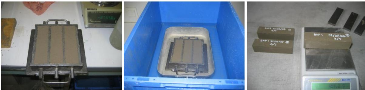
*Figure III-7 : Confection des éprouvettes prismatiques en mortier autoplaçant*
