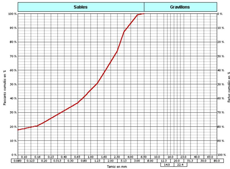
*Figure II-3 : Courbe granulométrique du sable 0/5*
