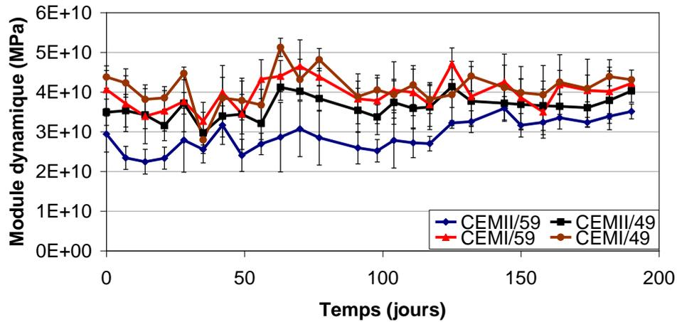
Figure III-34 : Variation du module dynamique des mini-cylindres en fonction du temps - Immersion/séchage à 105°C
