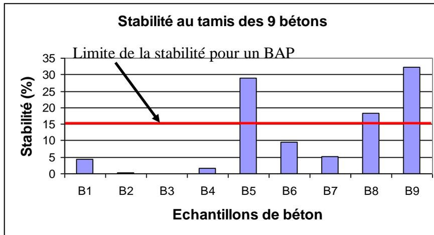
Figure II-12 : La stabilité des différents bétons confectionnés
