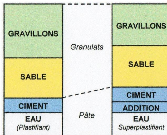
Figure II-1 : Composition d'un béton ordinaire et d'un BAB [25]
