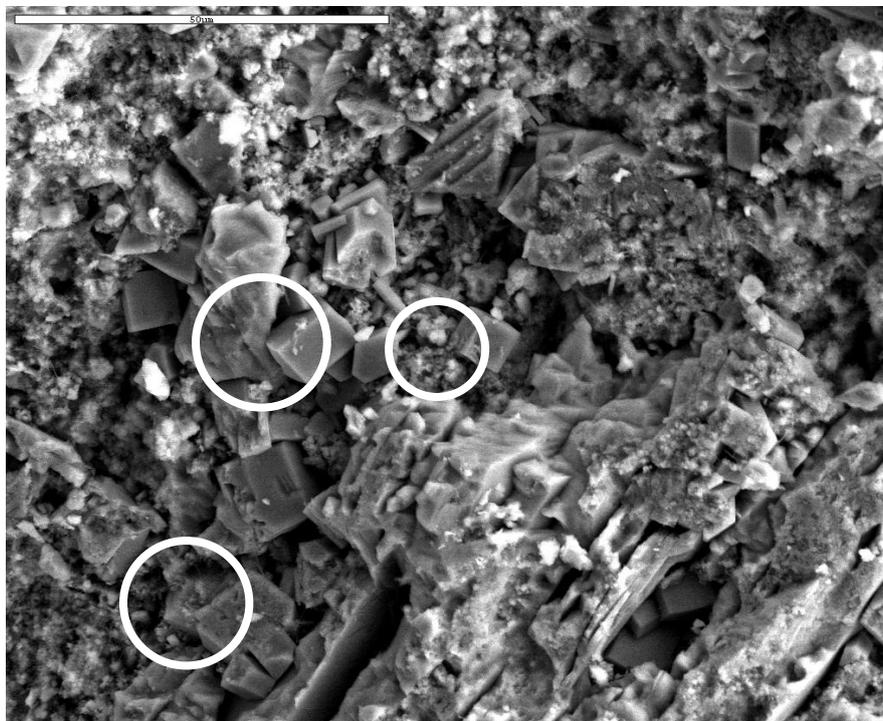
*Figure IV-47 : Fracture (x1000/5kv) - CEMII/59 en I/S à 105°C*
