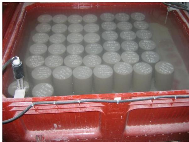
*Figure II-16 : Mode de Conservation des échantillons avant leur écrasement*
