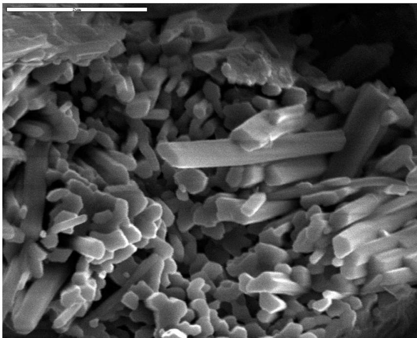
*Figure IV-46 : Fracture (x20000/5kv) - CEMII/59 en I/S à 60°C*
