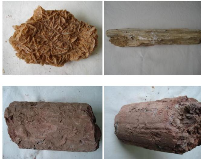
*Figure III-1 : Quelques échantillons de roches gypseuses existantes dans les sols*
