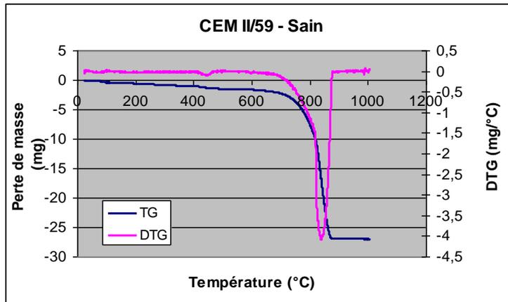
*Figure IV-15 : Analyse thermogravimétrique de l'échantillon CEM II/59 sain*
