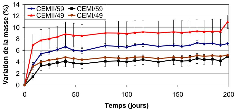
Figure III-23 : L'évolution de la masse des mini-cylindres en fonction du temps
