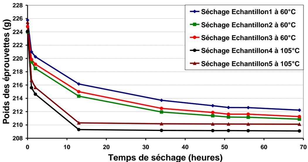
*Figure III-15 : Séchage des échantillons 4 x 8 cm en béton*
