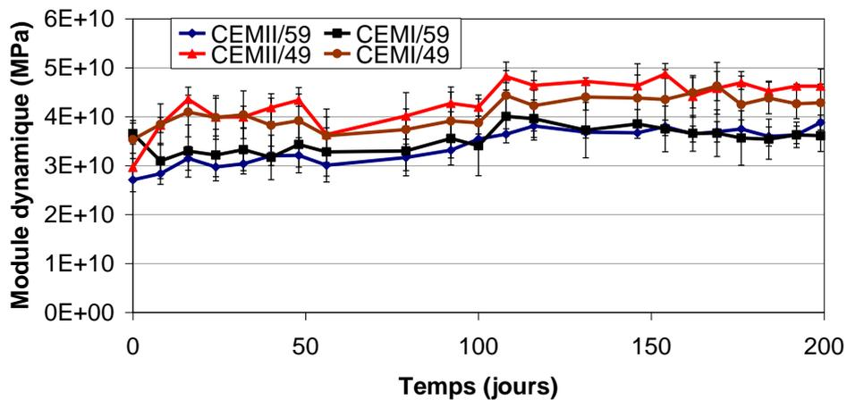
Figure III-24 : Evolution du module dynamique des mini-cylindres en fonction du temps
