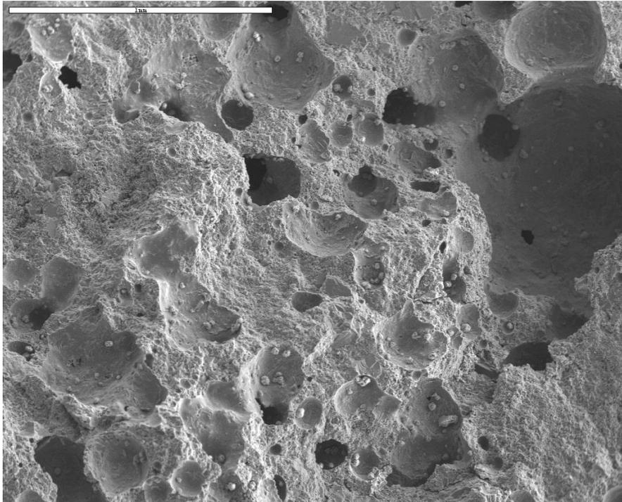
*Figure IV-55 : Fracture (x50/5kv) – CEM I/59 en I C*
