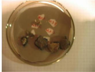
*Figure IV-31 : Fractures préparées pour l'analyse au MEB*
