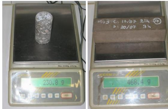
Figure III-18 : Prise hebdomadaire des masses des échantillons
