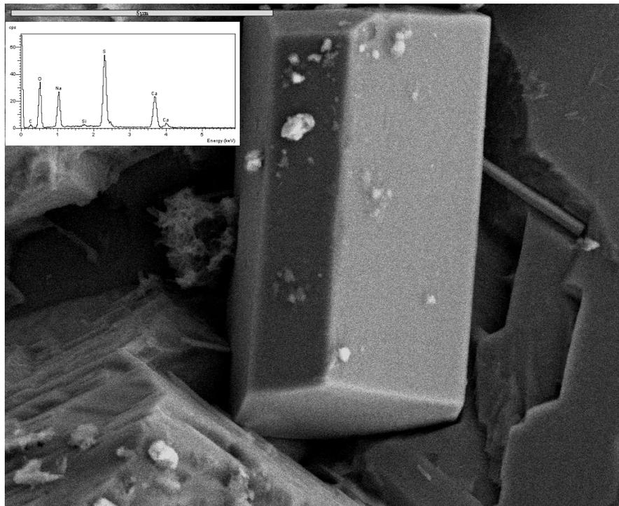
*Figure IV-48 : Fracture (x10000/5kv) - CEMII/59 en I/S à 105°C*
