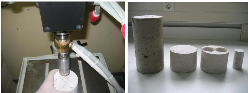
*Figure III-11 : Confection des mini-cylindres en béton*
