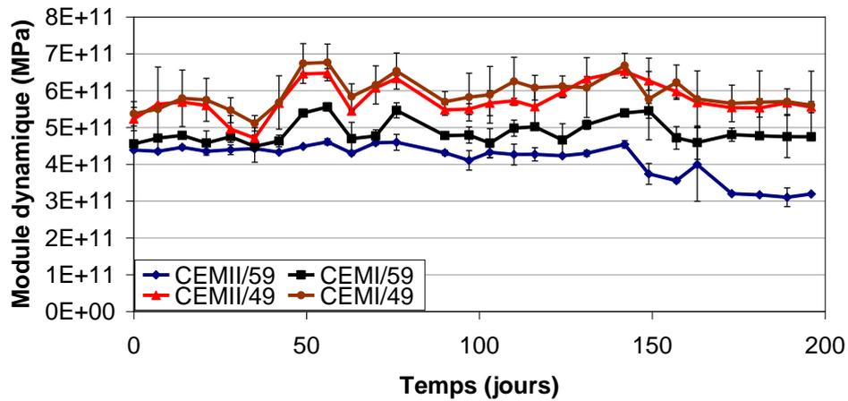
Figure III-49 : Variation du module dynamique des cylindres 11x22 cm en fonction du temps - Immersion complète
