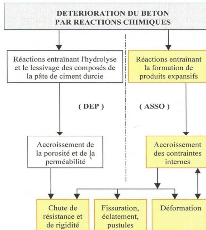
*Figure I-16 : Schéma simplifié des processus de détérioration du béton intervenant lors des attaques sulfatiques (DEP : Dégradation en Eau Pure, ASSO : Attaque au Sulfate de Sodium  $\text{Na}_2\text{SO}_4$ ).*
