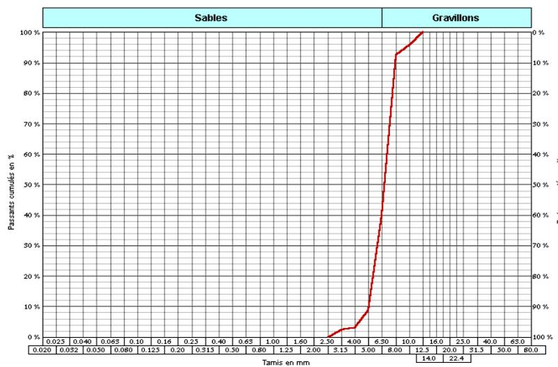
*Figure II-4 : Courbe granulométrique du gravier 5/8*
