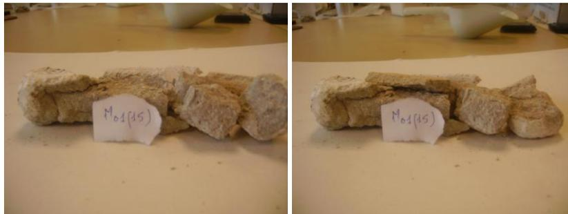
*Figure III-29 : Ruine totale des mortiers issus des bétons CEMII/59 - Immersion/séchage à 105°C*
