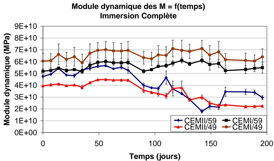
Figure III-57 : Variation du module dynamique des mortiers en fonction du temps - Immersion complète
