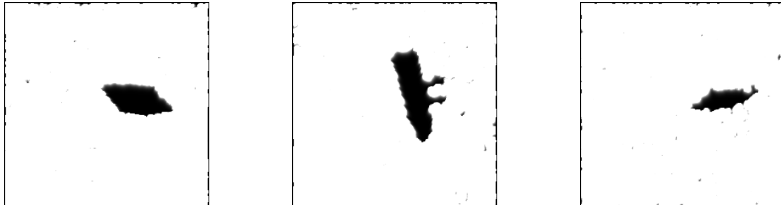
Figure V.9: Segmentations des ombres de mines avec les composantes AM obtenues avec le DHODA
