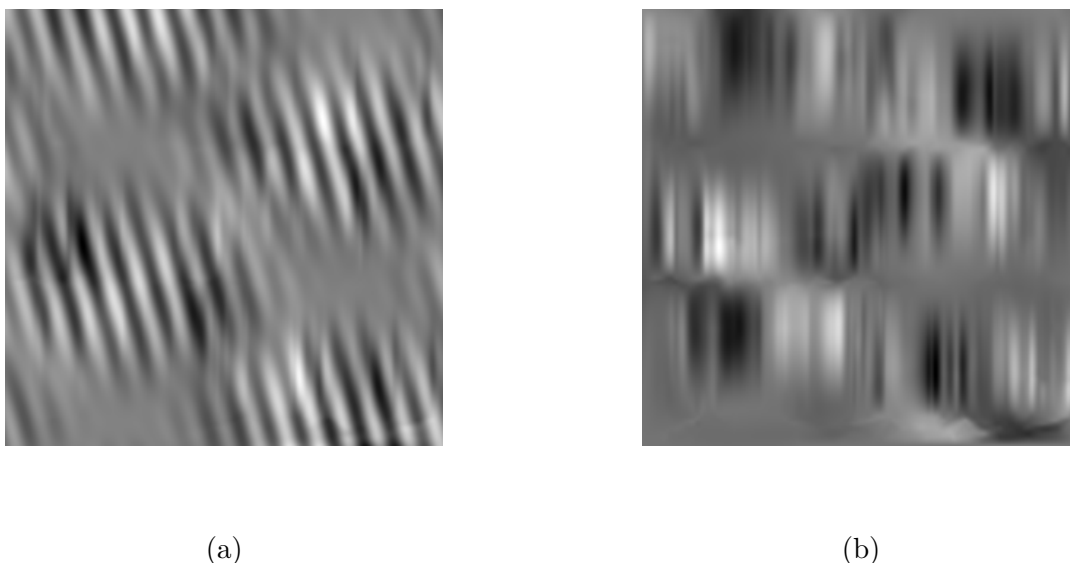
Figure III.7: Modes empiriques obtenus avec l'EMD 2D. Première 2D IMF (a). Deuxième 2D IMF (b)
