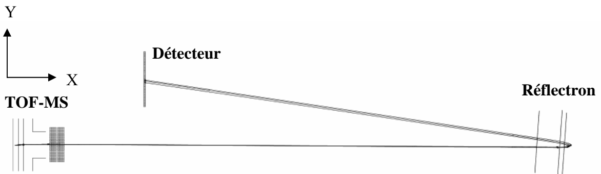
Figure 19 : image du montage final du spectromètre de masse à temps de vol et du réflectron tel qu'il apparaît dans l'interface graphique du logiciel Simion. La trace des ions permet de visualiser leur parcours jusqu'au détecteur. La mauvaise qualité de l'affichage ne permet pas de voir toutes les plaques du réflectron, elles sont visibles dans la Figure 21.
