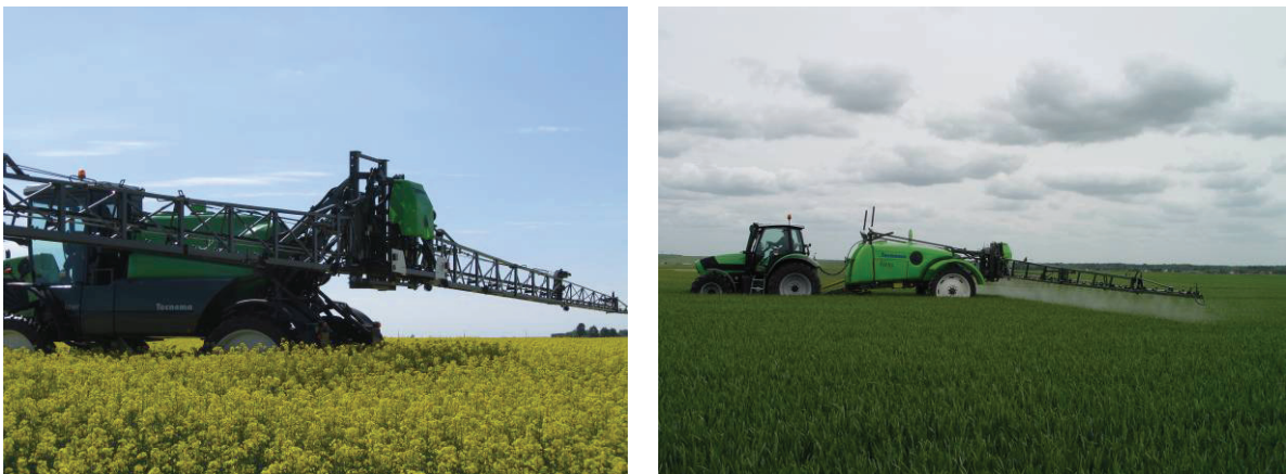
Fig. I.3 : Les pulvérisateurs Automoteur Laser 4240 (à gauche) et traîné Fortis Evolution (à droite) par Tecnomat proposent des rampes jusqu'à 42m et peuvent contenir plus de 4 000 litres de bouillie (eau+produit phytosanitaire) (Tecnomat, 2009).
