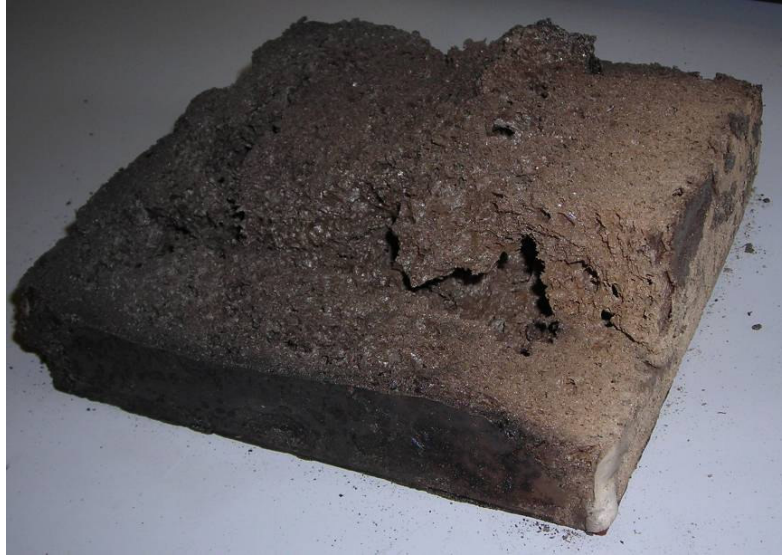
Figure 3.25 : couche charbonneuse obtenue au four électrique puis découpée
