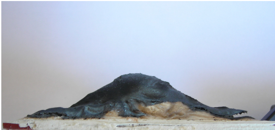
Figure 2.14 : gonflement observé suite à l'exposition à un flux Gaussien
