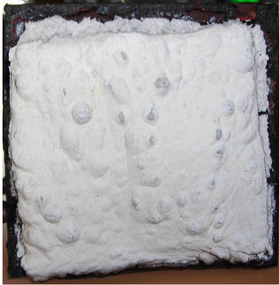
Figure 3.24 : couche charbonneuse obtenue au FSP (vue de dessus)
