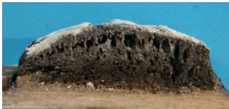
Figure 1.44 : vue en coupe du revêtement après l'essai
