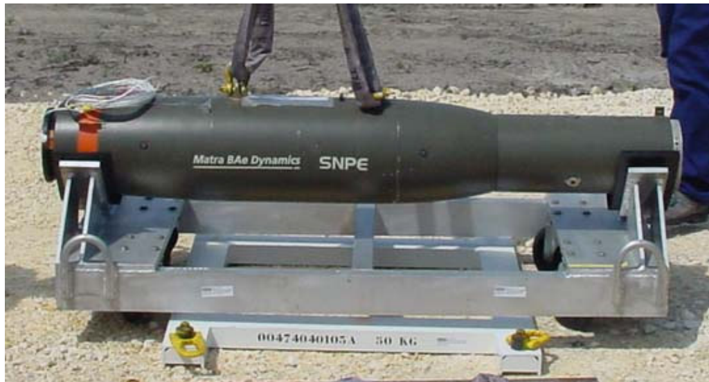
Figure 1.4 : CBEMS revêtu de peinture intumescente lors d'un essai de tenue au feu
