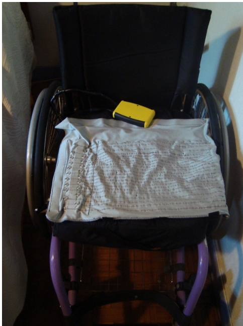
(b) La nappe de pression en tissu extensible
