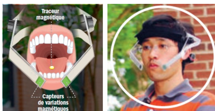
(a) Le Tongue Drive System permet, via un aimant sur la langue et des capteurs magnétiques de détecter les mouvements linguaux.
