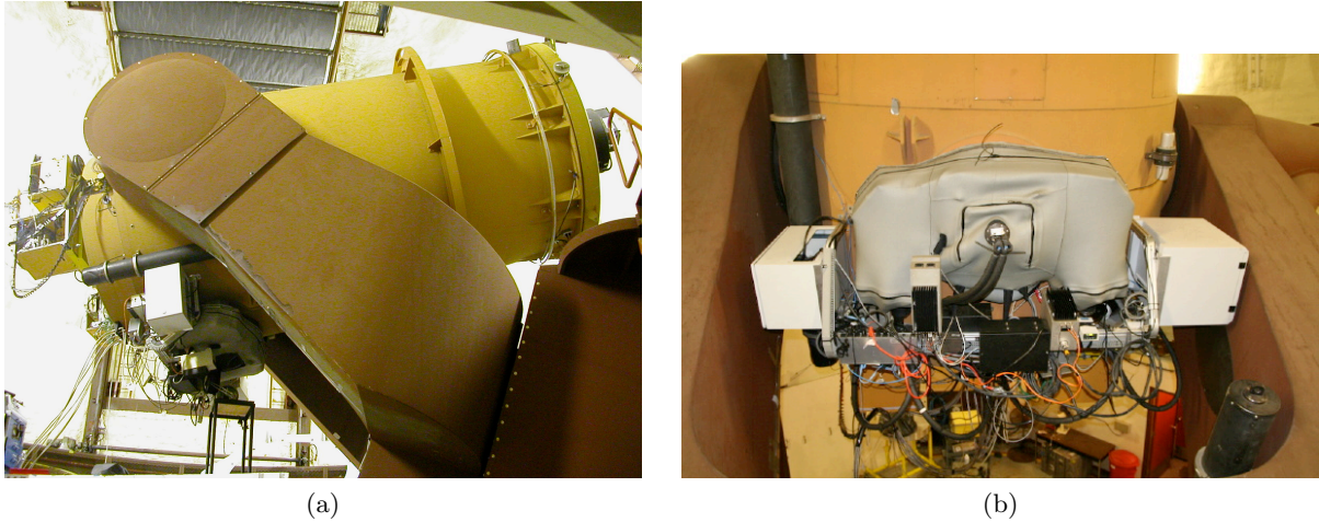
FIG. 2.1: (a) Télescope de l'Université d'Hawaii 2.2m (UH88); (b) SNIFS dans sa couverture de néoprène monté sur le port Cassegrain replié de l'UH88
