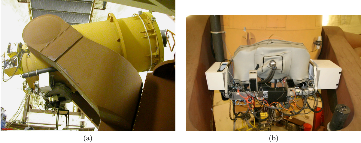
FIG. 2.1: (a) Télescope de l'Université d'Hawaii 2.2m (UH88) ; (b) SNIFS dans sa couverture de néoprène monté sur le port Cassegrain replié de l'UH88
