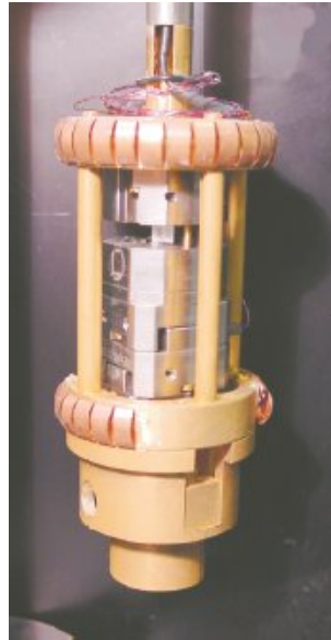
FIG. 2.7 – Photographie de la canne de micro-PL utilisée pour nos mesures.
