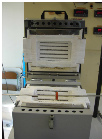
Fig II.5 : Photographie du four utilisé pour chauffer la cellule.
