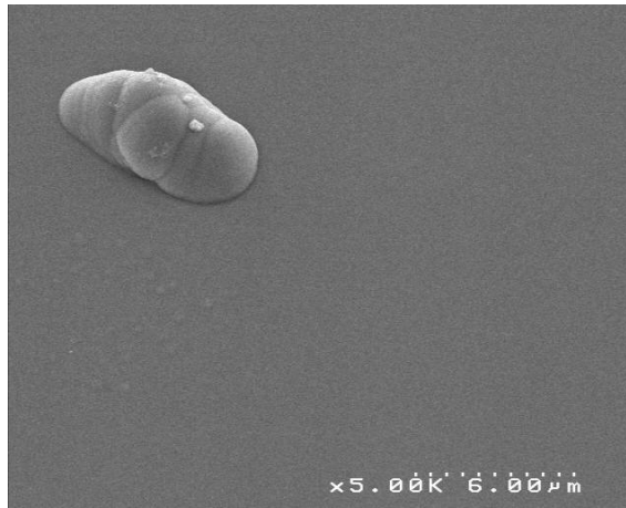
Fig.III.2. : Photo MEB montrant la formation de nucléations ponctuellement observées pour X=1
