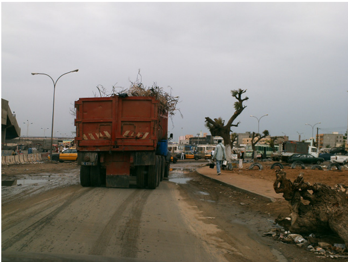
Photo 101 & 102. Camions avec plateforme arrière peu volumique ou inadaptée, utilisé pour... la collecte, le transport et la mise en décharge des Om et assimilés à Mbeubeuss. (Cliché DIWARA A-B 2007 ).
