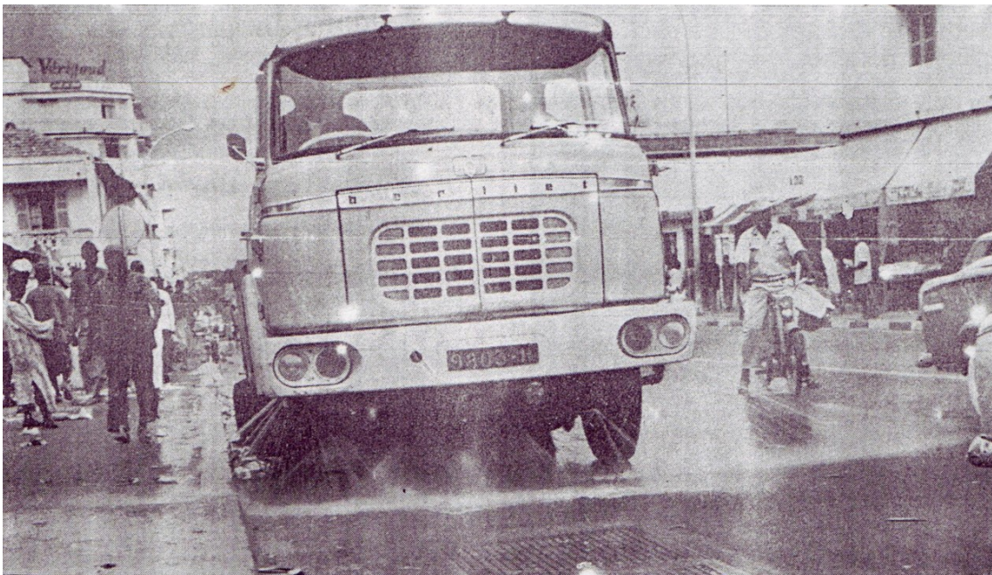
Photo 51. Camion arroseur-balayeur équipé d'un dispositif mécanique de balayage et de nettoyage à l'eau de la voirie. Ce modèle était celui utilisé dans les années 1960 par les Services Techniques de la Commune de Dakar.
