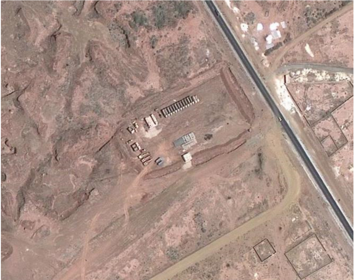
Photo 126. Image aérienne 16. Entrée du futur CET entre Ndiass et Sindia dans le département de Thiès sur la Nationale Dakar-Kaolack. Le site correspond à une ancienne carrière d'exploitation de matériau de terrassement (argile ou latérite rouge) utilisé notamment pour la construction de l'autoroute à péage Dakar-Diamniadio. La zone semble intéressante : le substrat ferrugineux imperméable et non fissuré, réduit les risques de percolation de lixiviats, alors que le niveau de la nappe qui présente une profondeur supérieure à la norme de 2 mètres, la met à l'abri des pollutions. Tectonique stable : pas de mouvements et site protégé des vents du littoral Nord. L'installation devrait être pourvue d'une clôture et d'un portail d'entrée, d'un pont de pesage, de bâtiments pour bureaux et services de systèmes de captage des gaz, ainsi que de réseaux d'égouts etc. Le site pourrait dans une optique de gestion métropolitaine recevoir les déchets des agglomérations de Dakar, Thiès et même de Mbour. Sa réhabilitation par reboisement pourra laisser place à un périmètre vert d'une superficie d'environ 70 hectare 10 à 15 ans après son remplissage. (Crédit photo Google earth 2009).
