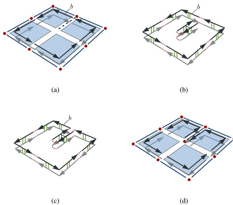
FIG. 5.6: Insertion d'une arête pendante dans une face. (a) Situation initiale de la face. (b) Quatre nouveaux brins sont ajoutés et cousus entre eux pour former une arête pendante. (c) Les brins sont reliés au sommet incident à  $b$ . (d) Le lignel et le pointel qui correspondent à l'arête et le sommet pendant sont allumés.
