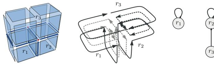
FIG. 8.6: Exemple du parcours de la surface externe de l'union de deux régions  $r_1$  et  $r_2$  où  $r_2$  représente un ensemble disjoint de deux régions ( $r_2$  et  $r_3$ ). Les faces en pointillés gris sont les faces intérieures entre  $r_1$  et  $r_2$ . Les faces en pointillés noirs sont les faces intérieures à l'ensemble disjoint représenté par  $r_2$ . Tous les brins en pointillés sont ignorés durant le parcours de surfaces : seuls les brins dessinés en trait plein sont traités.
