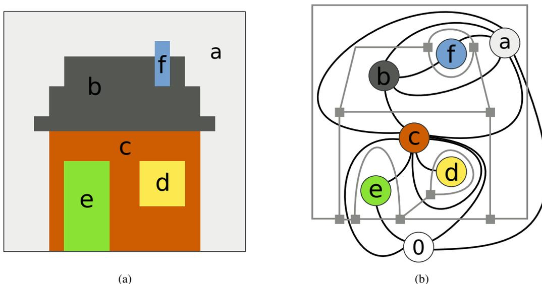
FIG. 1.17: Graphes duaux utilisés pour représenter la partition d'une image : (a) Image 2D avec 6 régions étiquetées de  $a$  à  $f$  ; (b) graphe primal (en traits noirs) et graphe dual (en traits gris) représentant la partition de l'image. La région infinie  $0$  qui entoure l'image est ajoutée au graphe d'adjacence. Nous remarquons notamment la boucle dans le graphe primal représentant l'imbrication de la région  $b$  dans la région  $c$ .
