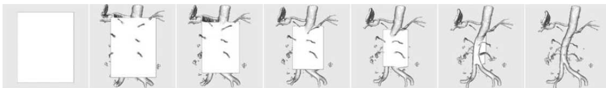
FIG. 3.10: Résultat de la segmentation (3D) de vaisseaux sanguins en faisant évoluer la boîte englobante par divisions successives. La partition résultat ne contient pas d'anses.
