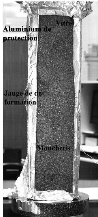
FIGURE 3.22: Préparation d'une éprouvette  $7 \times 7 \times 28$  cm pour l'analyse d'images
