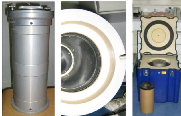
**FIGURE 3.24:** Schéma d'un calorimètre semi-adiabatique
