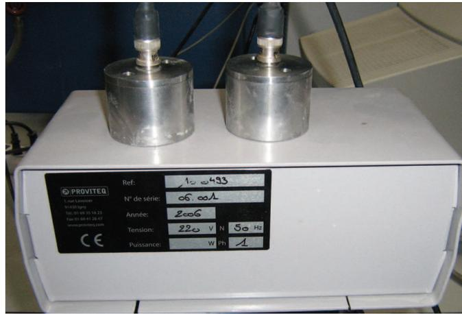
FIGURE B.3: Appareil à ultrasons PUNDIT PLUS
