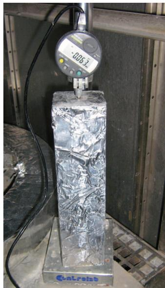
FIGURE 3.10: Vue générale du montage de mesure du retrait développé
