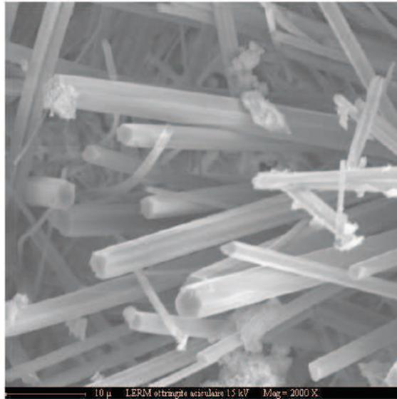
**FIGURE 1.2:** MEB Ettringite aciculaire (aiguille) dans un béton [Mitani, 2003]
