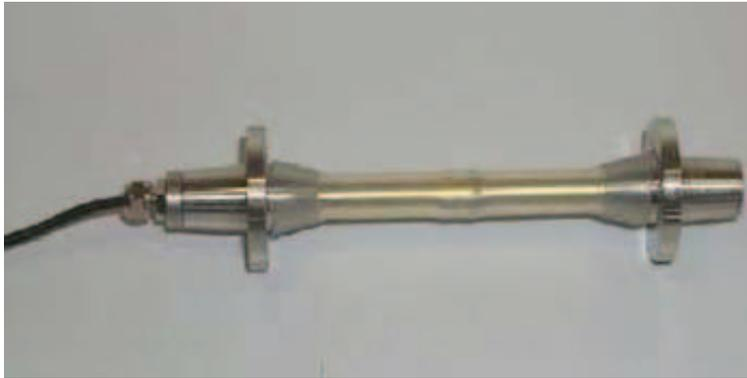
FIGURE 3.26: Capteur à corde vibrante employé pour les essais sur structures massives
