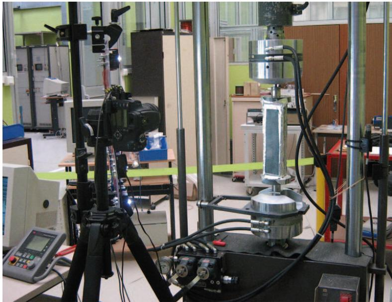
**FIGURE 3.21:** Montage de l'essai de fluage avec analyse d'images
