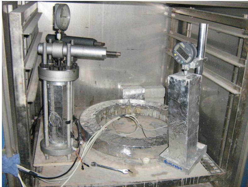
**FIGURE 3.17:** Vue d'ensemble du banc d'essai de fluage et de retrait mesuré à l'anneau
