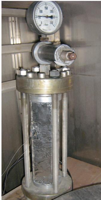
**FIGURE 3.19:** Bâti de fluage en compression développé
