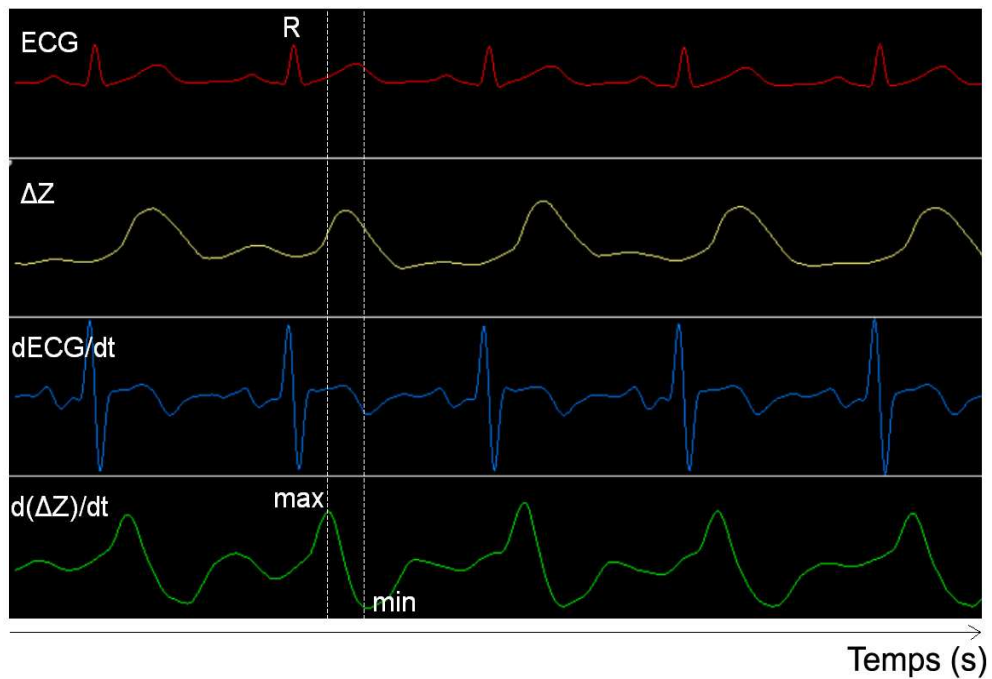
Figure 2.4 – Enregistrement du signal d'impédance et du signal électrocardiogramme à l'aide du dispositif PhysioFlow des laboratoires Manatec France. L'impédance bioélectrique est notée Z , les variations d'impédance bioélectrique sont notées \Delta Z et la dérivée des variations d'impédance bioélectrique est notée d\Delta Z/dt .
