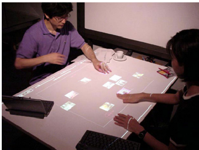
Figure 13 : La table interactive basée sur le système SmartSkin permettant des interactions multi-utilisateurs
