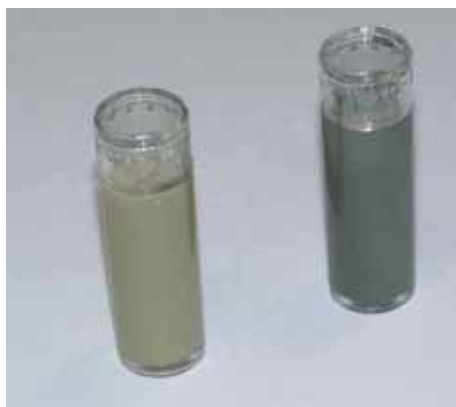
Figure II.28 – Photos des solutions de colloïdes d'argent de taille moyenne 35 nanomètres (gauche), et la solution de colloïdes d'argent après centrifugation (droite).
