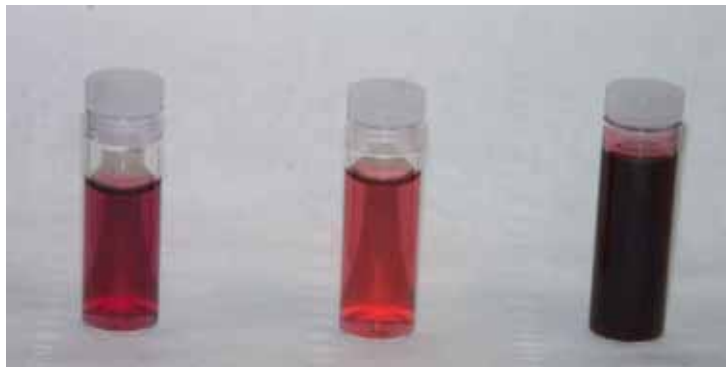
Figure II-3 - Les solutions de colloïdes d'or de gauche à droite (a) diamètre moyen de 5 nm, (b) diamètre moyen de 22 nm, (c) solution de colloïdes d'or après centrifugation
