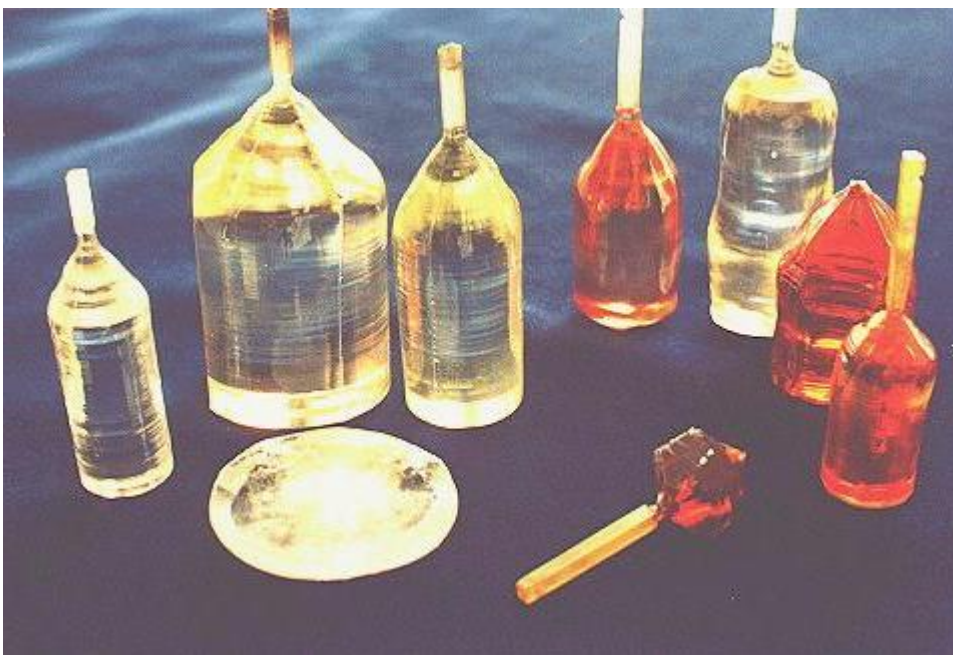
FIG. 1.4: Cristaux massifs de niobate de lithium pures et dopées (K. Polgar)
