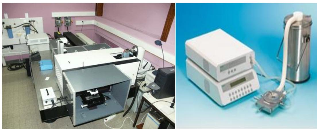
Figure III. 35: Spectromètre LabRam HR800 (à gauche) et platine Linkam (à droite).
