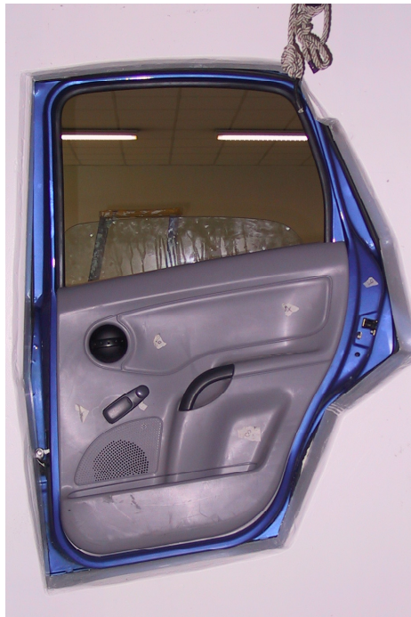
Figure 41. Photo de l'intérieur d'une portière de C3 de PSA (Peugeot – Citroën Automobile). L'étude porte sur l'éventuelle mise en œuvre d'une microperforation d'une garniture de portière automobile
