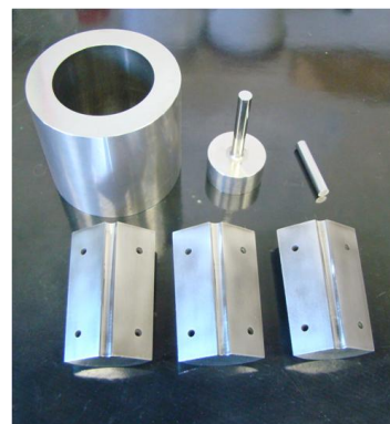
b) Pièces composant la matrice cylindrique « en trois parties »
