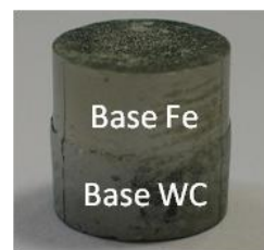
Figure 3 : Photographie d'un échantillon bimatériau fritté
