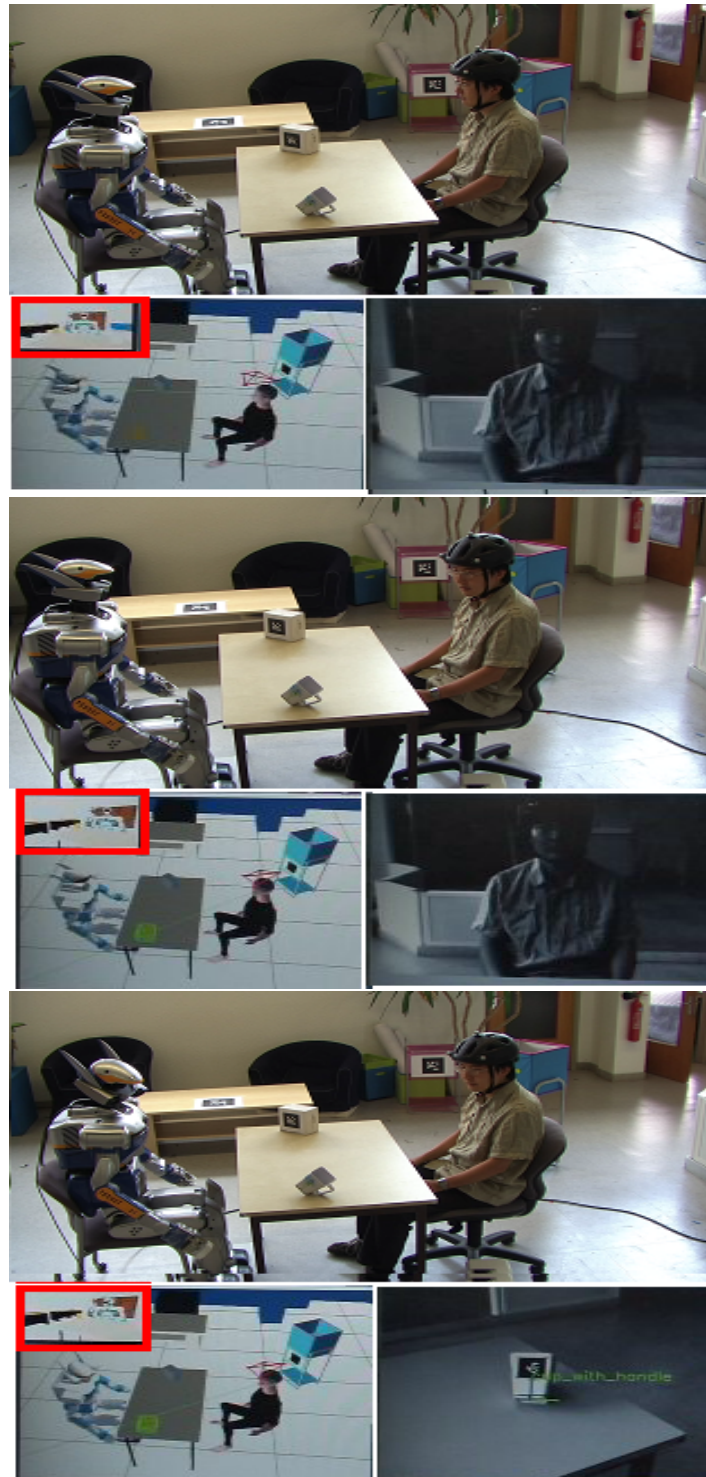
Figure 7.6: Scenario 1: Séquence d'images qui montre comment le robot raisonne sur le point de vue de l'homme et après, il regarde au même objet que la personne en face de lui est en train de regarder.
