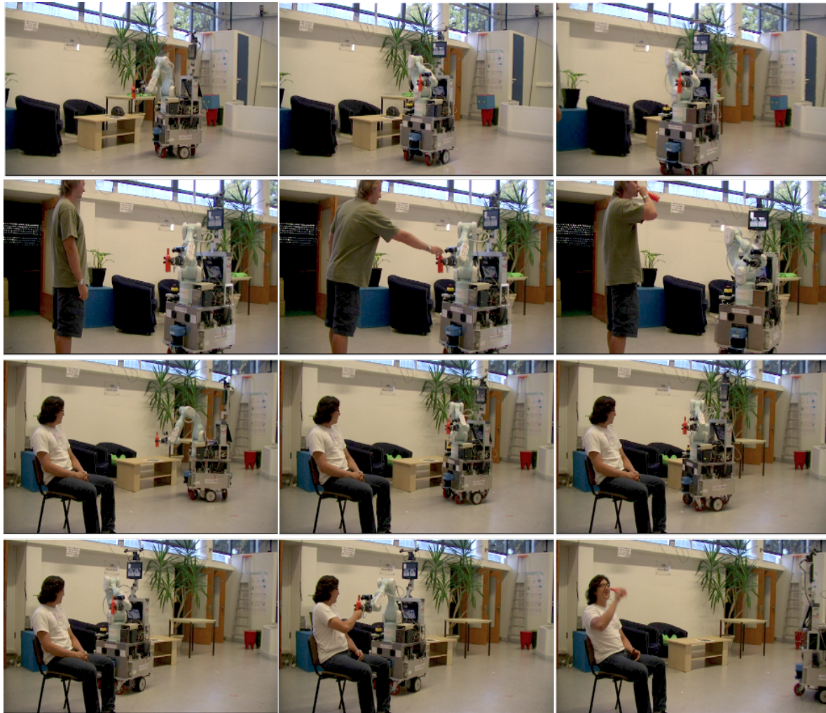
Figure 7.4: Un scénario complet d'une tâche "prends et donne". La séquence montre que le robot qui doit emporter une bouteille à l'homme en deux cas; dans le premier cas l'humain est debout et dans le deuxième il est assise, le robot s'adapte à chaque état de l'humain.
