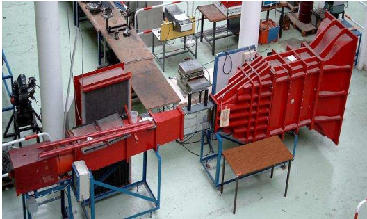
Figure 16. Soufflerie du type Eiffel.
