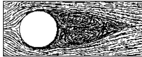
Fig. 2 : dépressions à l'arrière du cylindre
