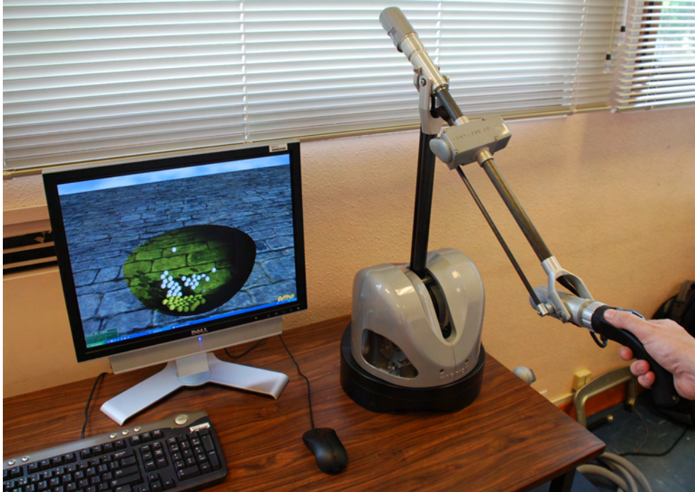
FIG. 4.1 – Manipulation effectuée sur un bras Virtuose 6D-35/45.
