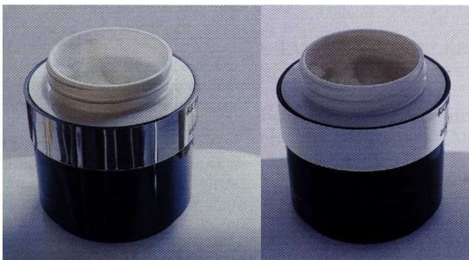
FIG. 2.1 – Photographie illustrant l'influence de l'environnement sur l'aspect visuel d'un objet. Un flacon avec un bouchon lisse réfléchissant (à gauche) est placé dans un environnement possédant un éclairage isotrope uniforme où il apparaît alors mat (à droite). (Photo de Robert Sève [Sève, 2004])
