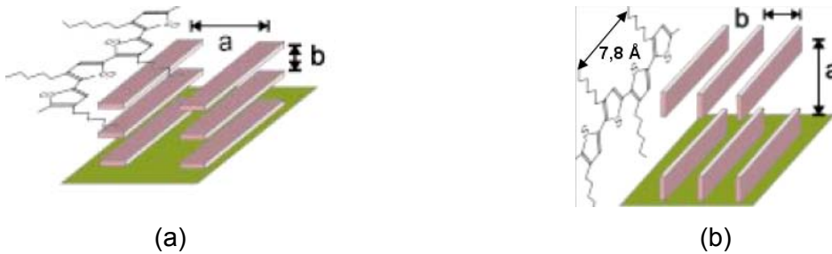
Fig. VI.5 : Orientations des domaines ordonnés du P3HT par rapport au substrat : parallèle (a) et perpendiculaire (b) [adaptée de 1]
