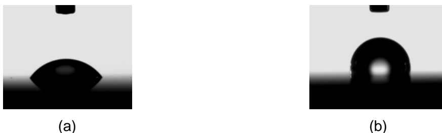
Fig. V.2 : Augmentation de l'angle de contact avec l'hydrophobicité de la surface : wafer oxydé ( 31^\circ ) (a), wafer oxydé fonctionnalisé avec de l'OTS ( 108^\circ ) (b)
