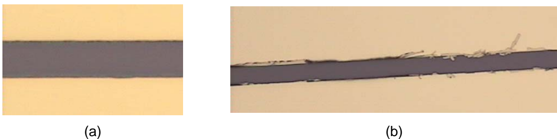
Fig. V.6 : Microscopie optique d'un canal de 10 µm réalisé avec des électrodes d'or (a), et d'un canal de 5 µm réalisé avec des électrodes de platine (b)
