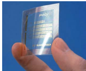
Fig. A.3 : Modèle d'une étiquette RFID flexible sur substrat polymère (PolyIC) [6]
