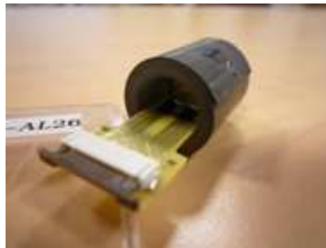
Figure IV-44. Exemple de réalisation d'un capteur de courant précis où la structure de capteur de courant choisie est entourée par une multicouche de matériaux ferromagnétiques
