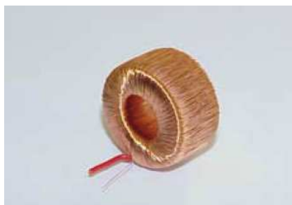
Figure I-2. Exemple de transformateur torique.
