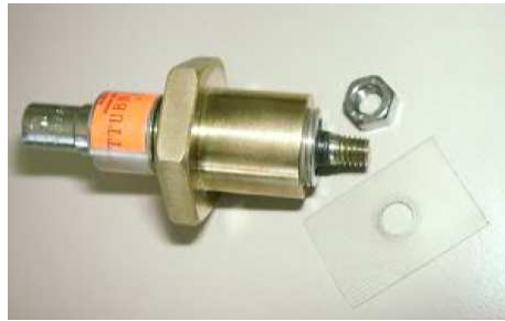
Figure I-1. Shunt coaxial avec une plaque d'isolation [BIL - 2003].
