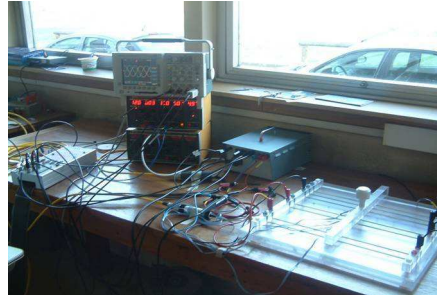
Figure IV-1. Banc de mesure formé par des sources d'alimentation, un oscilloscope, une chaîne d'acquisition et des capteurs magnétiques de type fluxgate.
