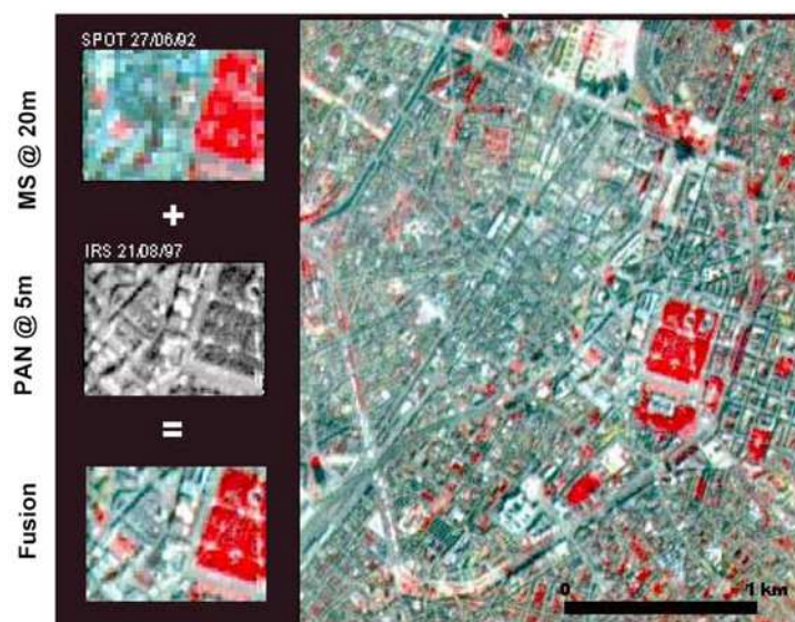
Figure 8: Exemple de la fusion d'une image panchromatique avec une image multispectrale (© Université Libre de Bruxelles).
