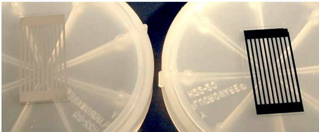
Figure 111 : Photographie de fenêtres VNIR « côté télescope », face miroir (à gauche) et absorbeur (à droite).
