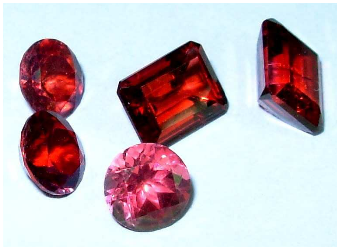
Figure 1.3 – Pierres décoratives en oxyde de zirconium recouvertes d'un revêtement nanocomposite Au/SiO 2 . On remarquera la couleur rouge rubis typique des nanoparticules d'or. Les dépôts de nanocomposites ont été effectués dans le cadre des travaux de cette thèse. Photo : Oleg Zabeida.
