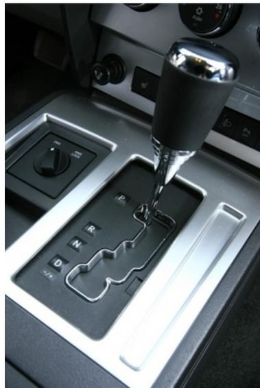
FIGURE 8.2 – Exemple de levier de boîte automatique
