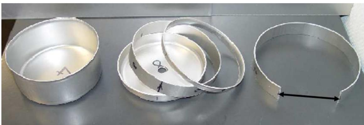
FIG. 2.28 – Godet embouti puis découpe de l'anneau et mesure du retour élastique après ouverture de l'anneau sur l'alliage d'aluminium Al5754.
