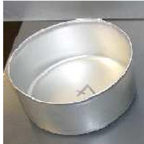
FIG. 2.20 – Godet cylindrique en alliage d'aluminium Al5754.
