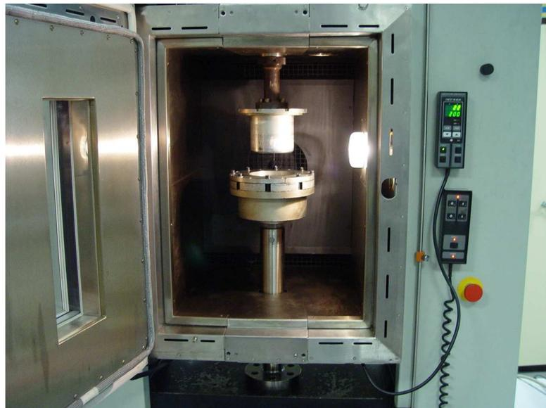
FIG. 5.4 – Dispositif d'emboutissage placé dans l'enceinte thermique.
