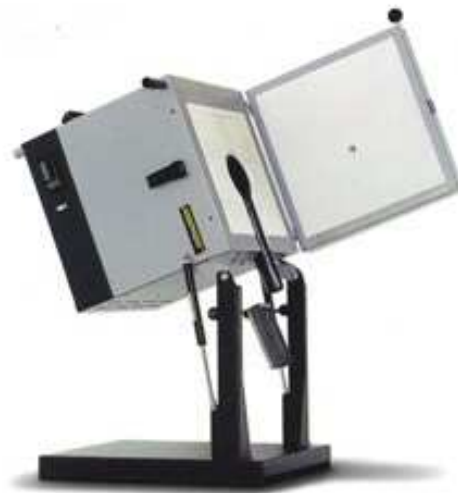
Figure 3-3 : Four basculant de laboratoire utilisé en fonderie [NAB]
