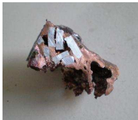
Figure 3-4 : Photographie d'un échantillon de cuivre coulé en fonderie avec l'ajout de chrome en morceaux.
