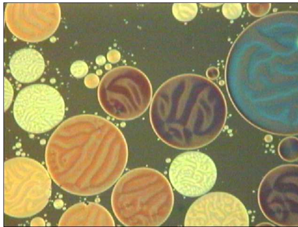
Fig. 5.3: Coexistence de domaines nématiques 6CB d'épaisseurs différentes. Taille de l'image environ 500\ \mu\text{m} \times 400\ \mu\text{m} environ.
