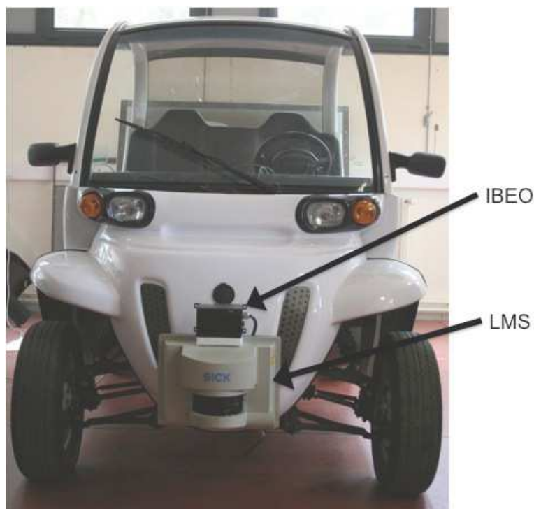
Figure 10.7: Capteurs installés sur le véhicule du laboratoire SET
