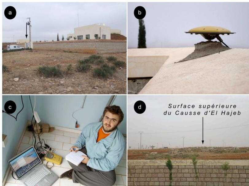
Figure 90 : a) La station GPS de El Hajeb, la flèche noire indiquant l'emplacement de l'antenne ; b) Gros plan sur l'antenne après réinstallation ; c) Electronique d'acquisition et récupération des données ; d) Vue vers l'ouest des terrains environnants de la station, située sur la surface supérieure Causse d'El Hajeb.
