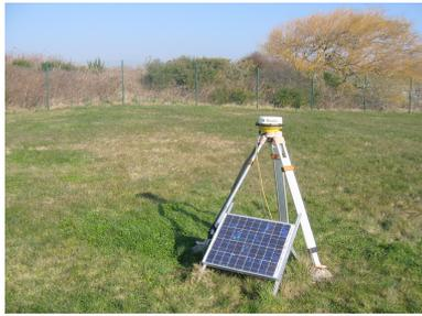
Figure 63 : Station GPS EPUR, située sur le site de la station d'épuration de Ploemeur. Cette station sera la station de référence dans notre étude de la déformation.
