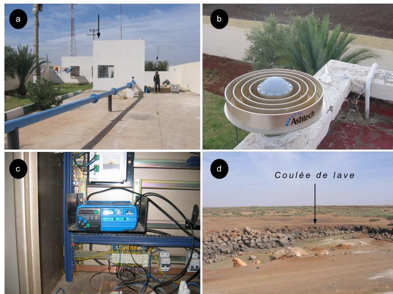
Figure 89 : a) La station GPS de Souk Jemad El Gour. La flèche noire indique l'emplacement de l'antenne. b) Gros plan sur l'antenne ; c) Electronique d'acquisition ; d) Vue vers l'est de la coulée basaltique quaternaire du Jbel Outigui.
