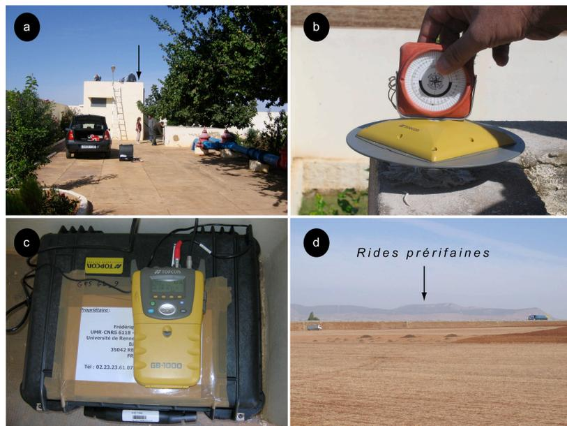
Figure 88 : a) La station GPS de Haj Kaddour. La flèche noire indique l'emplacement de l'antenne ; b) Gros plan sur l'antenne ; c) Electronique d'acquisition ; d) Vue vers le nord : au premier plan, les terrains environnants de la station et au fond les rides préifaines.
